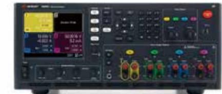
N6705C 直流电源分析仪通过集成多达 4 个具有 DMM、Scope、Arb 和 Data Logger 功能的高级电源, 为直流电压和电流测量提供了生产力。无需收集多个设备并创建复杂的测试设置, 就能测量流入 DUT 的电流。无需通过开发和调试程序来控制仪器集合, 前面板提供了所有功能和测量组件。N6705C 直流电源分析仪可与 14585A 控制和分析软件一起使用。N6705C 提供灵活的配置, 以满足您的电源和分析要求。
