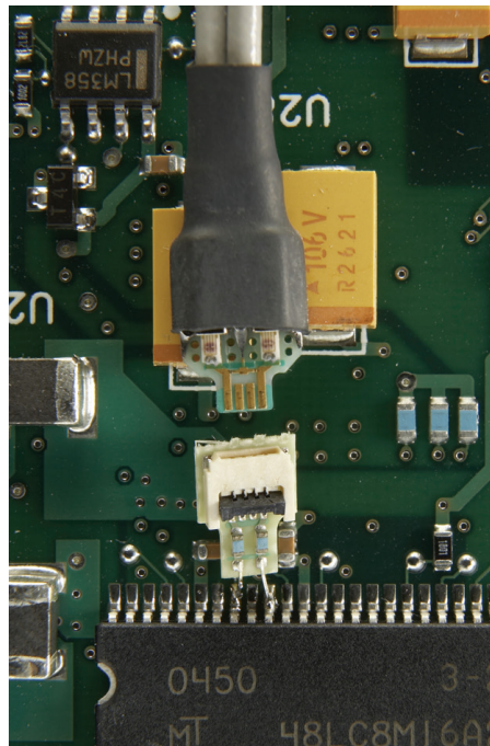
InfiniiMax ZIF tip soldered on board
