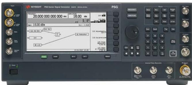
Der E8267D Vektor-Signalgenerator dient zum Testen hochentwickelter Empfänger mit realistischen breitbandigen Eingangssignalen bei Radar-, EV-Satellitenübertragungs- und 5G-Anwendungen. Er bietet eine Bandbreite bis zu 2 GHz (mit externer AWG), um komplexe elektromagnetische Umgebungen nachzubilden und komplexe Signalerzeugungszeiten zu reduzieren.
