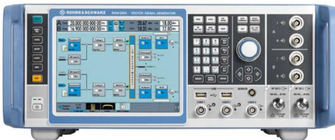
Il SMW200A è il generatore di segnale vettoriale per le applicazioni 5G più esigenti. Quest'apparecchiatura offre flessibilità, risultati e un funzionamento intuitivo per la generazione di segnali complessi di alta qualità, a modulazione digitale, per le applicazioni da 2G a LTE Advanced e 5G.
