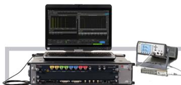
Les testeurs de radars automobiles de la série **E8740A de Keysight** permettent de générer et d'analyser des bandes de fréquences de 24GHz, 77GHz et 79GHz, avec des largeurs de bande d'analyse de 2,5GHz à >5GHz pouvant être sélectionnées. Des niveaux de précision d'amplitude de  $\pm 1$ dB et une résolution de 10 bits peuvent être pris en charge.
