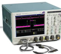
Avec une bande passante allant jusqu'à 33GHz et un taux d'échantillonnage de 100Gé/s, l'oscilloscope **DPO7000DX de Tektronix** est pour sa part très bien adapté à l'examen des phénomènes à grande vitesse. Il possède 16 canaux logiques et une résolution temporelle de 80ps. Associé au progiciel TekExpress Automotive Ethernet, il fournit une solution hautement optimisée pour l'examen de l'infrastructure de réseaux embarqués multi-Gbit (avec une disposition pour la validation TSN 802.1Q incluse).
