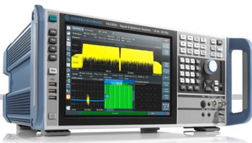
Prenant en charge une gamme de fréquences allant de 10Hz à 44GHz, l'analyseur de spectre **R&S®FSV3000 de Rohde & Schwarz** est un outil précieux pour la vérification du matériel de communication V2X, notamment en relation avec le protocole 802.11p. Il possède une bande passante d'analyse atteignant 200MHz et une sensibilité (typique) de -90dBm.
