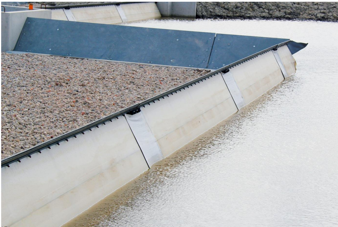
Figuur 21; proefopstelling van de vlotterkering. Bron: Dura Vermeer
