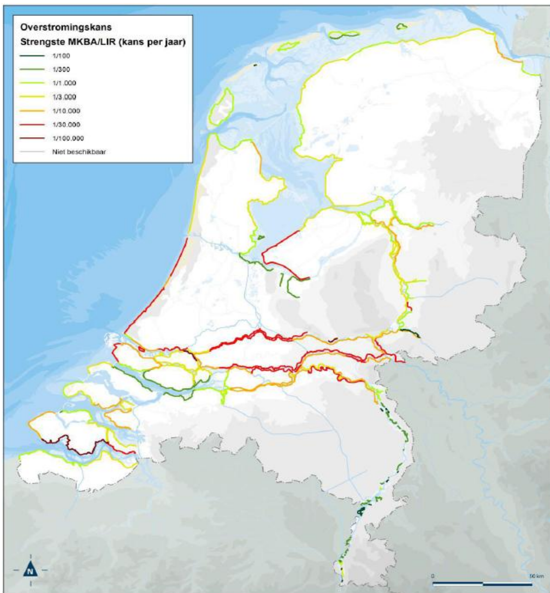
Figuur 20; waarschijnlijke definitieve nieuwe normering voor primaire keringen. Deze normen gelden als alleen maatregelen in laag 1 getroffen worden. Normen zijn op sommige plaatsen hoger dan ze ooit geweest zijn; met kansen als 1:30.000 en 1:100.000 per jaar. Deze kaart is afkomstig uit het synthesesdocument 3.0 van Deelprogramma Veiligheid voor DP2015.
