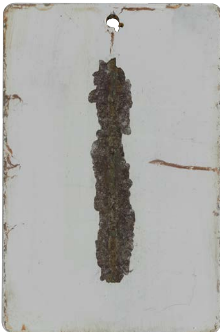
Enskiktssystem med enbart topplack efter 720h NSS
