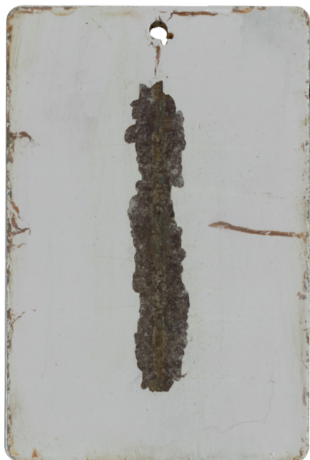
Acabado del sistema monocapa después tan solo 720 h (niebla salina neutra)
