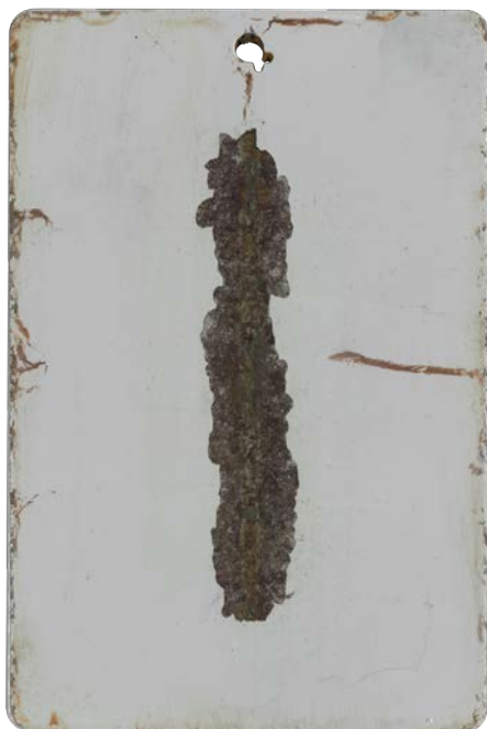
1-kerrosmaali 720 tunnin jälkeen (Neutraali suolasumu testi)
