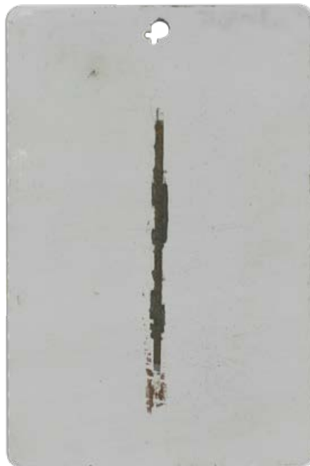
Imprimación para sistemas de doble capa + capa de acabado después de 720 h (niebla salina neutra)
