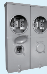
200A - Deux groupes avec disjoncteurs Siemens Type Q de 100A, 22kA, enceinte de type 3R étanche aux intempéries (aussi disponible 3 et 4 groupes) # MICCO12100HI
