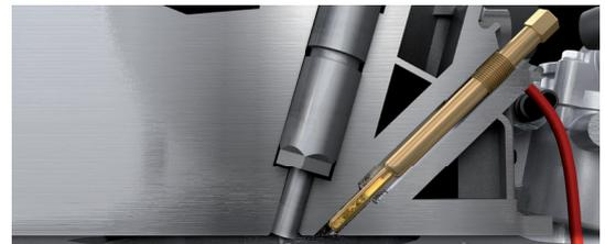
Vor dem Einbau neuer Glühkerzen sollten die Ölkohle- und Rußrückstände mit einer eingefetteten Reibahle aus der Glühkerzenbohrung entfernt werden.
