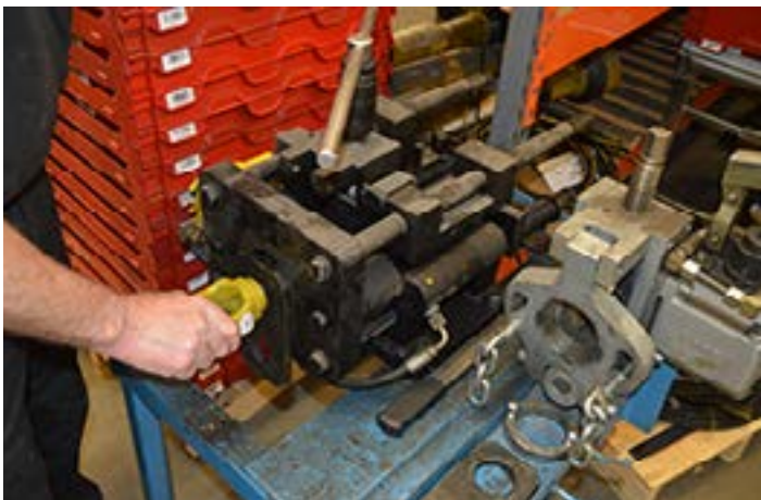
Assemblage de prises de force avec tube et protection.
