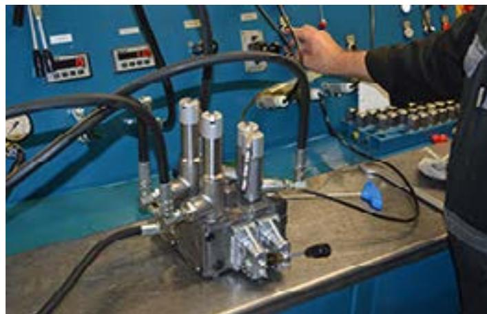
In unserer Werkstatt verfügen wir über eine moderne hydraulische Testanlage, mit der wir Cetop-Ventile, aber auch andere Ventiltypen wie PVG-Ventile testen können. Zudem verfügt die Anlage über die gängigsten elektrischen Signale von schwarz/weiß bis proportional. Durch den externen Zapfwellenanschluss haben wir die Möglichkeit, Pumpen bis zu einer Leistung von 75 kW anzutreiben.
