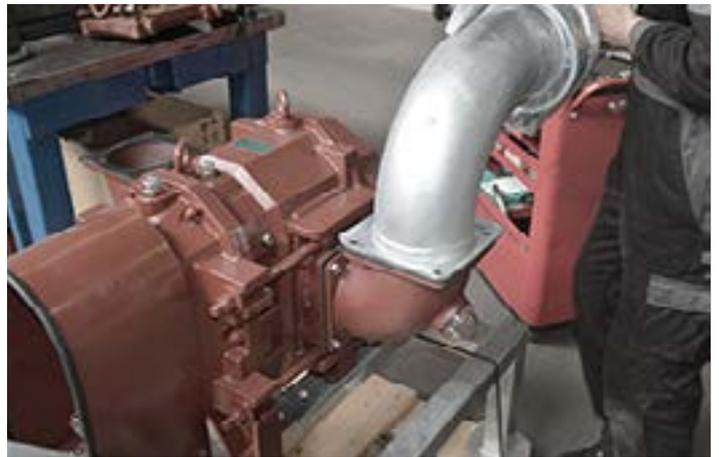
Das Zusammenstellen von Güllepumpensystemen, z. B. durch Montieren eines Steinfängers, wird in unserer Werkstatt ausgeführt.
