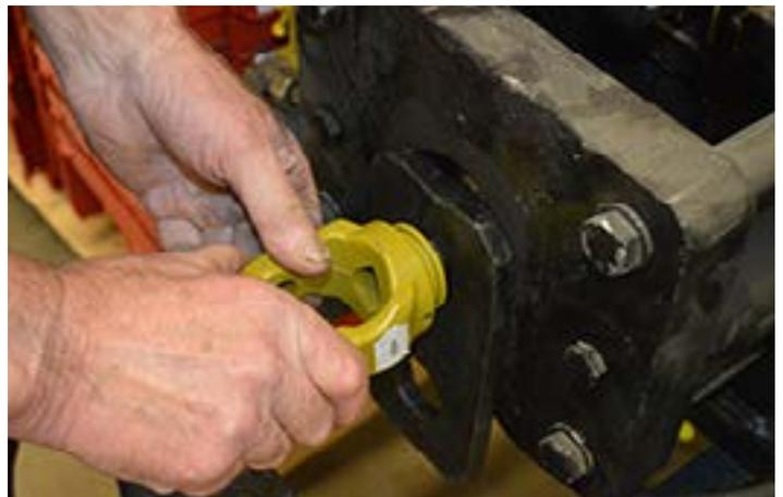
Montage von Gelenkwellen mit Rohr, Gabel, und Schutz.
