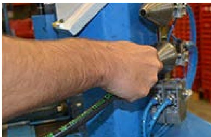
Pressen von Hydraulikschläuchen mit unterschiedlichen Pressarmaturen und Durchmessern.
