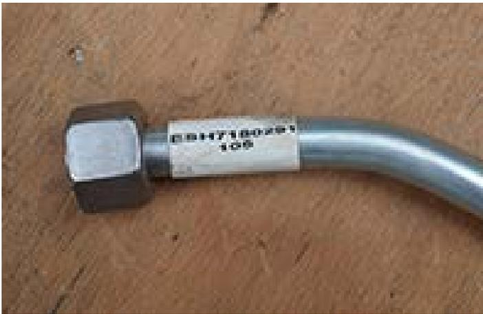
Vormontieren einer Schraubverbindung durch Pressen eines Schneidrings an die Leitung.
