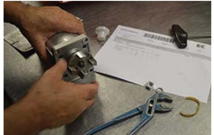
In der Werkstatt werden Mehrfachpumpen montiert; auch die Drehrichtung kann geändert werden. Zugleich werden auch Reparaturen durchgeführt, sofern möglich.
