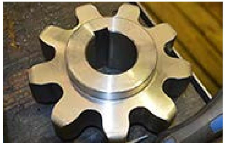
Keilnutziehen für Innenkeile, maximal 25 mm breit und über eine Länge von 80 mm.
