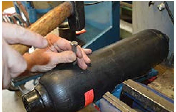
Wir können Druckspeicher bis zu einem Druck von 200 bar mit Stickstoff befüllen.
