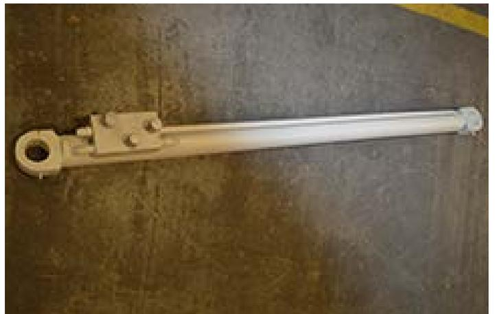
Da jeder Zylinder aus einem Rohr und einer Stange besteht, haben wir die Möglichkeit, nahezu jeden Zylinder zu überholen, denn wir haben die Kolbenstangen in verschiedenen Längen vorrätig. Bei einer Überholung oder Reparatur erhält der Kunde vorab einen Kostenvoranschlag.
