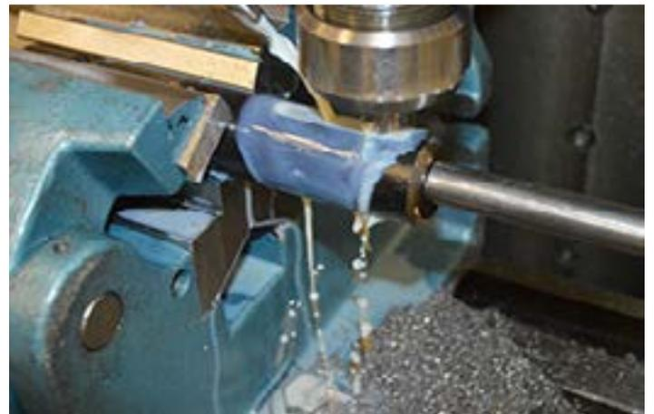
Fräsen einer Keilnut außen mit einer maximalen Breite von 28 mm.
