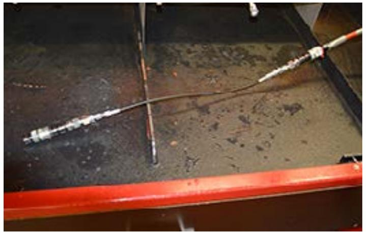
Zur Zertifizierung von Hydraulikschläuchen verfügen wir über eine Hochdruckanlage, die einen Maximaldruck von 2500 bar erzeugt.
