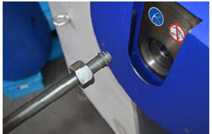
Befestigen einer Schraubverbindung durch Verformen der Leitung und Erzeugen einer Bördelung für die Überwurfmutter. Auf der Vorderseite wird ein spezieller Dichtungsring angebracht. Diese Form der Bearbeitung ist eine Alternative zum Schweißkegel.
