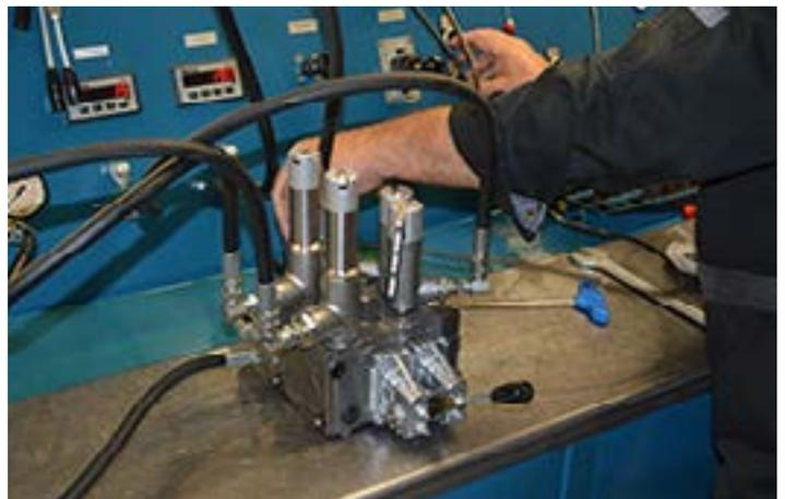
Nach Ihrer Konfigurationen wird das PVG-Ventil von Danfoss in der Werkstatt montiert und eingestellt.
