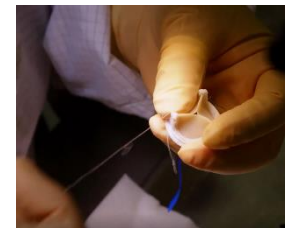
生体弁は現在も、十分な経験を積んだ社員の手でひとつひとつ手縫いで製造される（3ページ参照）
