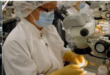
牛心のう膜を弁尖の形に1枚ずつ型抜きしていく
