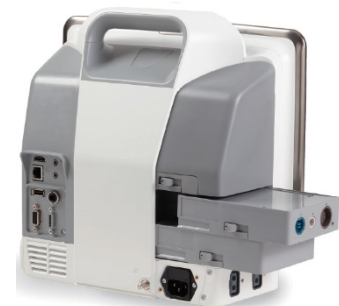
ヘモスフィアの背面画像。モジュールの選択とタッチパネルの操作により、シンプルにデバイスの切り替えが可能
