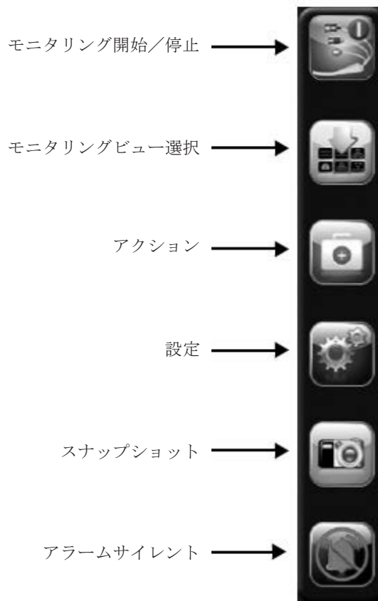
図 5-2 ナビゲーションバー—スワンガンツモジュールによるモニタリング
