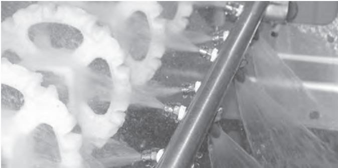
**Figura 120:** Il modello di spruzzatura è progettato specificamente per pulire la superficie inferiore del nastro, i pignoni e l'albero.
