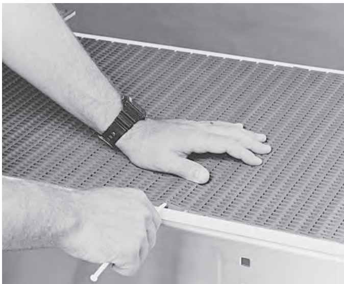
Figura 1: Moduli in plastica uniti da perni a cerniera
