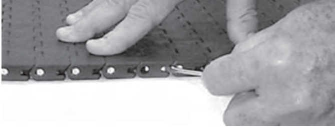
Figura 170: Ritenzione dei perni Slidelox
