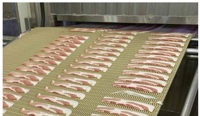
Taśma S900 Raised Rib Heavy-Duty Edge firmy Intralox
