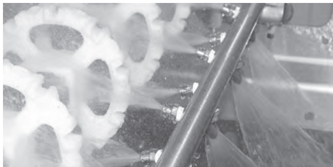
Rysunek 120: Wzór natryskiwania został zaprojektowany w celu dokładnego czyszczenia spodniej części taśmy, kół zębatach i wału
