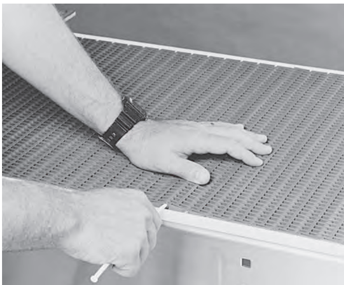
Rysunek 1: Plastikowe moduły połączone przy użyciu pinów łączących
