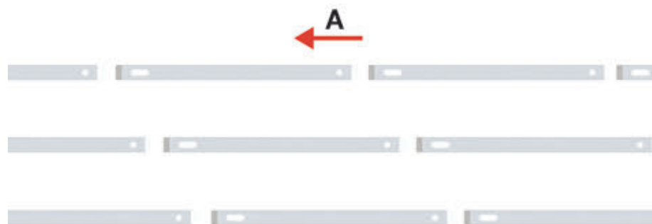
Figura 137: Padrão da guia de desgaste retilínea paralela
