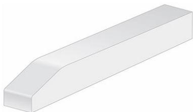
図 32: ウェアストリップ端の面取り
