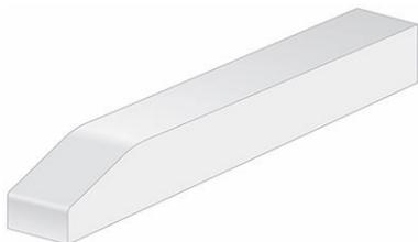
図 64: ウェアストリップ端の面取り
