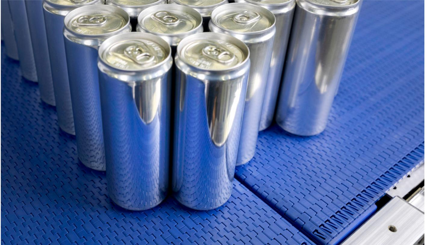
コンベアの平行搬送乗継ぎや不具合の多い乗継ぎををなくして不要なコンベアやベルト、メンテナンスの問題を解消します。570シリーズ・狭小乗継ぎベルトとIntralox®ノーズバー乗継ぎユニットが、シームレスに連携するよう設計されています。
