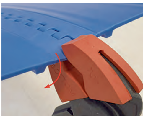
Figure 6: pliage du bord du tapis vers le bas pour saisir l'extrémité de l'axe
