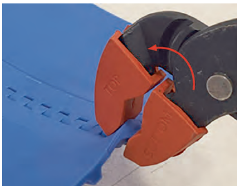
Figure 9: pliage du bord du tapis vers le haut pour saisir l'extrémité de l'axe
