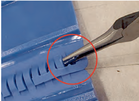
Figure 15: possibilité de retrait de l'axe à l'aide d'une pince placée entre l'extrémité de l'axe et le maillon captif
