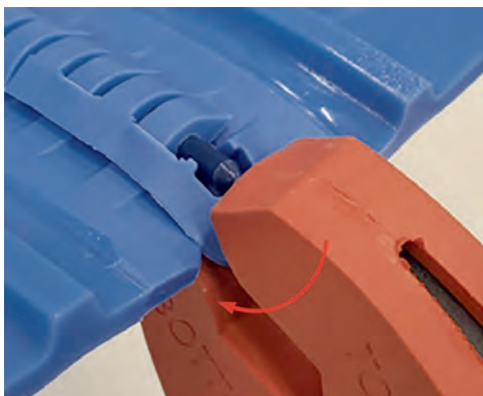
Figure 10: possibilité de retrait de l'axe avec la partie inférieure du ThermoLace orientée vers le haut
