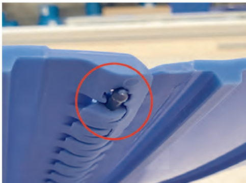
Figure 4: vérification que l'extrémité de l'axe se trouve à 0,125 pouce du bord du tapis
