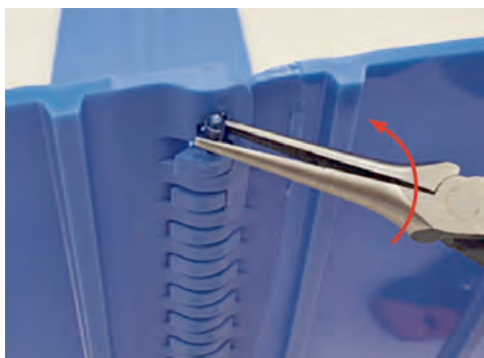
Figure 12: rotation de la pince dans le sens inverse des aiguilles d'une montre tout en maintenant la pression
