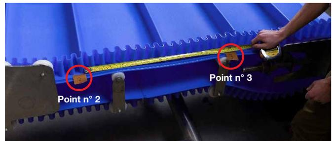
**ÉTAPE 4 :** répétez ce processus pour déplacer le point de départ sur l'ensemble du circuit du tapis jusqu'à revenir au point de départ.
