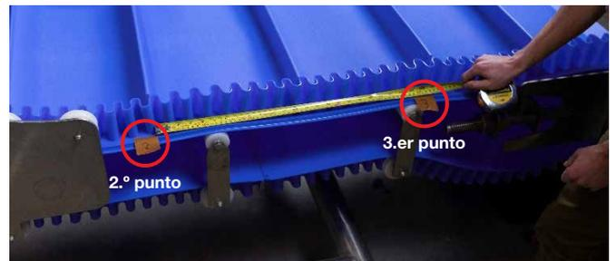
**PASO 4:** Repita este proceso para desplazar el punto de inicio por todo el recorrido de la banda hasta volver al punto de partida.
