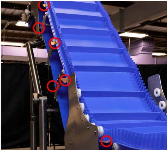
**PASO 5:** Sume todas las medidas anotadas para calcular la longitud de la banda.
