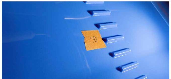
**PASO 4:** Repita este proceso para desplazar el punto de inicio por todo el recorrido de la banda hasta volver a la primera marca.
