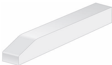
Rysunek 64: Fazowanie końcowe ślizgu
