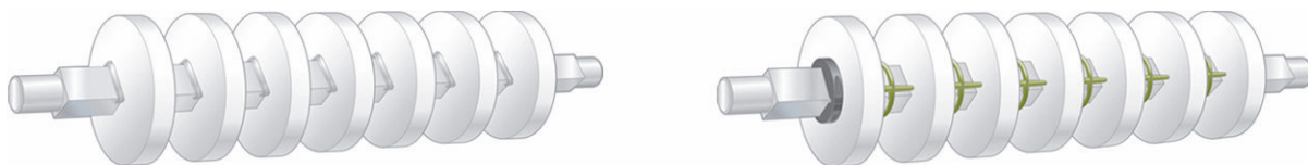
Rysunek 57: Pierścienie ustalające i elementy dystansowe kół zębatach
