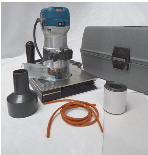
Rysunek 22: Zestaw do frezowania końców taśmy
