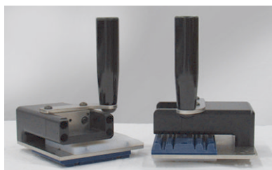
Rysunek 21: Ręczne narzędzie do przygotowania taśmy
