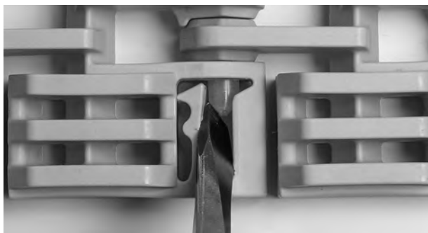
Figura 86: Spingere il perno oltre il dispositivo di ritenzione
