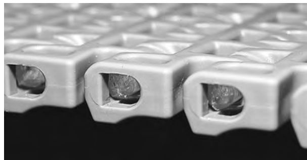
Figura 147: Assicurarsi che il perno sia inserito oltre il dispositivo di ritenzione
