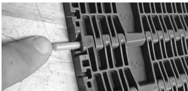
Figura 271: Inserimento del perno
