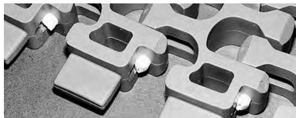
Figura 277: Assicurarsi che il perno sia inserito completamente
