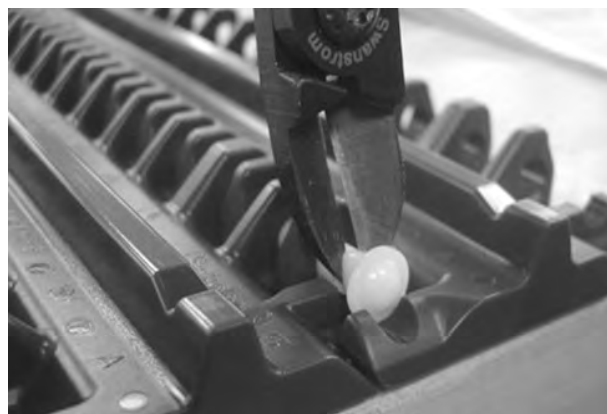
Figura 72: Tagliare la testa del perno
