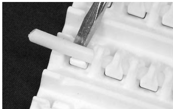
Figura 177: Sollevare il perno sopra il dispositivo di ritenzione
