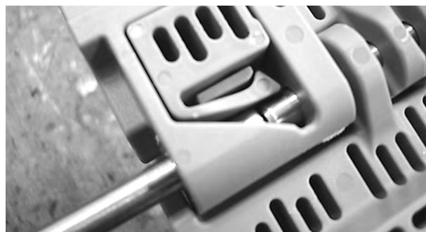
Figura 100: Spingere il perno oltre il dispositivo di ritenzione
