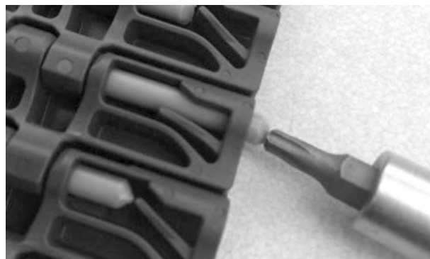
Figura 129: Spingere il perno oltre il dispositivo di ritenzione
