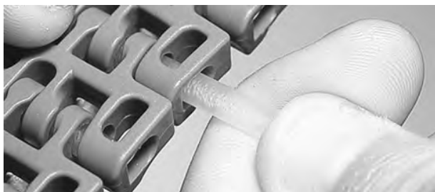
Figura 145: Inserire il perno nelle cerniere
