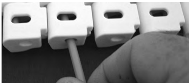
Figura 287: Inserire il perno nelle cerniere
