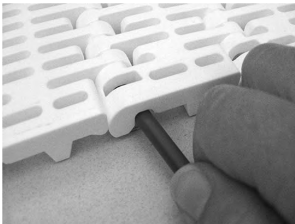
Figura 80: Spingere il perno nel nastro
