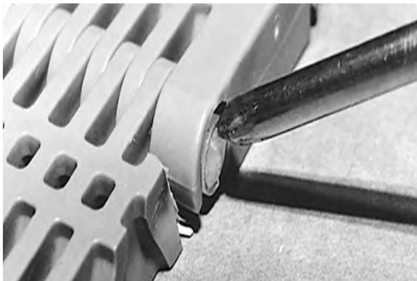
Figura 54: Spingere la testa del perno oltre il dispositivo di ritenzione
