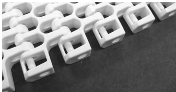
Figura 294: Assicurarsi che il perno sia inserito oltre il dispositivo di ritenzione
