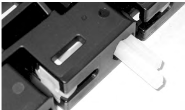
Figura 186: Inserire il perno nelle cerniere
