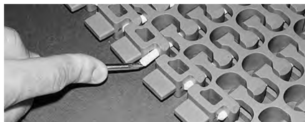
Figura 276: Assicurarsi che il perno sia inserito oltre il dispositivo di ritenzione
