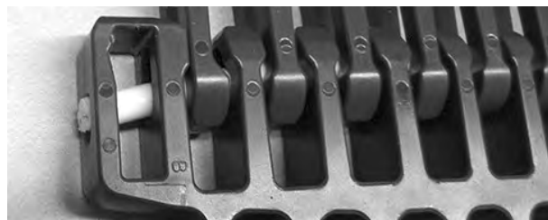
Figura 336: Inserire il perno nelle cerniere
