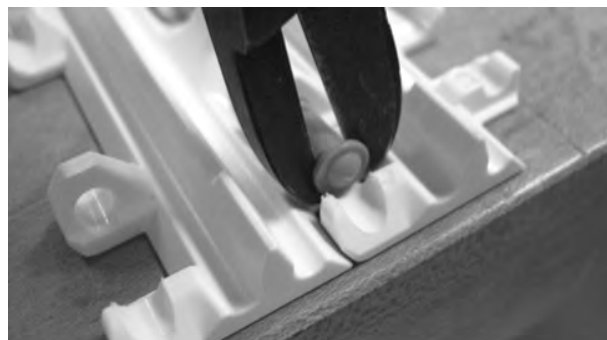
Figura 183: Tagliare la testa del perno
