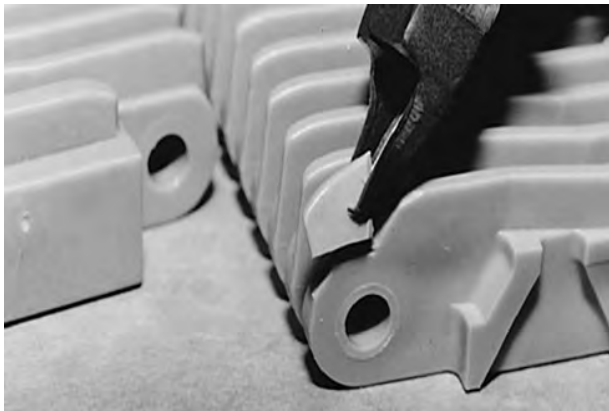
Figura 53: Tagliare la nervatura più esterna
