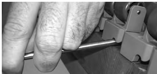
Figura 194: Inserire il perno in acciaio nella cerniera
