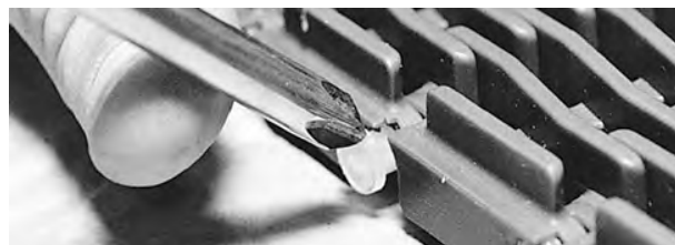
Figura 107: Spingere il perno nel nastro
