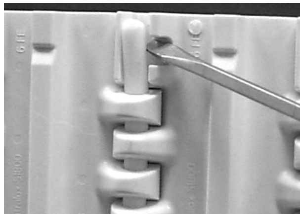
Figura 207: Sollevare il perno sopra il dispositivo di ritenzione
