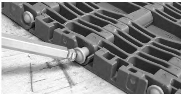
Figura 272: Spingere il pernetto oltre il dispositivo di ritenzione
