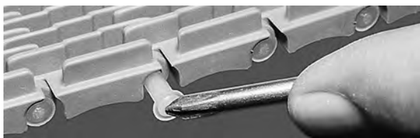
Figura 28: Spingere il perno nel nastro
