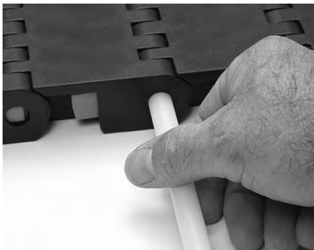
Figura 266: Inserimento del perno
