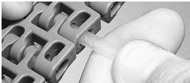
Figura 136: Inserire il perno nelle cerniere
