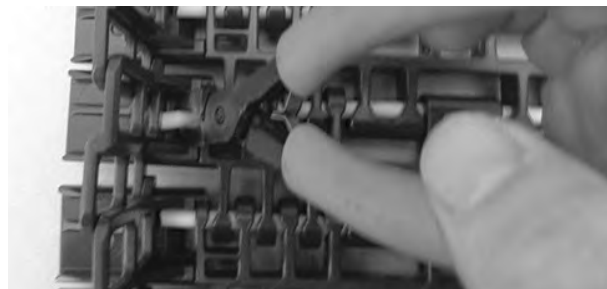
Figura 358: Estrazione del perno dal nastro
