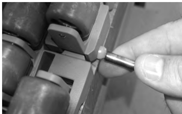
Figura 191: Spingere il perno oltre il dispositivo di ritenzione
