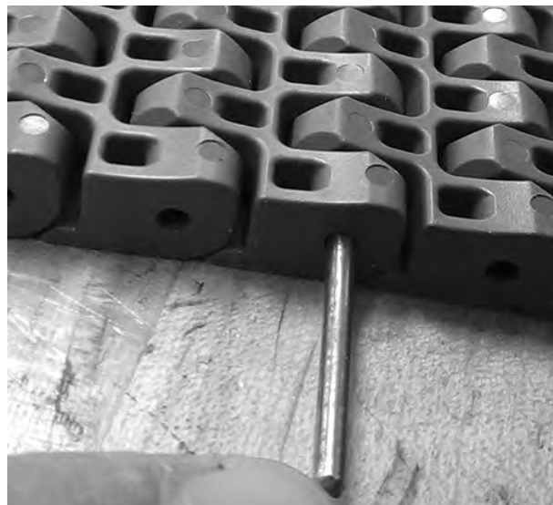
Figura 274: Allontanare il perno e il pernetto dal nastro
