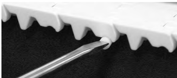
Figura 175: Spingere il perno oltre il dispositivo di ritenzione
