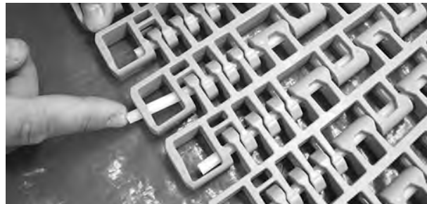
Figura 343: Spingere il perno oltre il dispositivo di ritenzione
