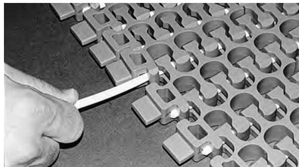
Figura 275: Inserimento del perno
