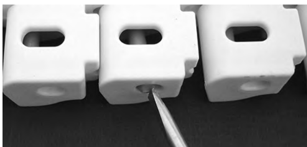
Figura 288: Spingere il perno oltre il dispositivo di ritenzione
