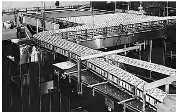
Figura 23: Posizionare i supporti su tutta la larghezza del nastro
