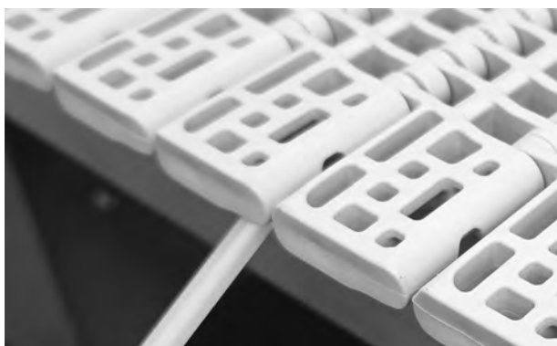
Figura 124: Inserire il perno sotto il bordo a filo
