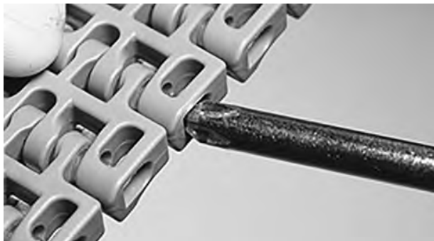
Figura 137: Spingere il perno oltre il dispositivo di ritenzione
