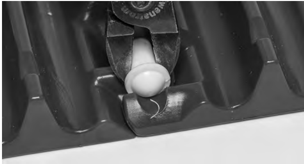
Figura 96: Tagliare la testa del perno
