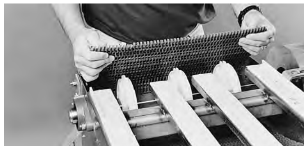
Figura 17: Far scorrere il nastro in basso lungo il tratto di ritorno
