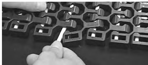
Figura 311: Inserire il perno nelle cerniere
