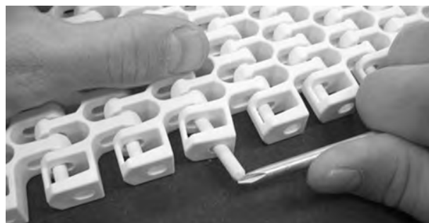
Figura 293: Spingere il perno oltre il dispositivo di ritenzione
