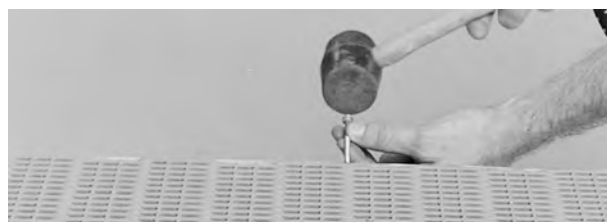
Figura 38: Allontanare il perno dal nastro
