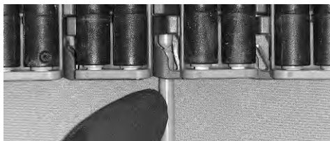
Figura 248: Spingere il perno oltre il dispositivo di ritenzione
