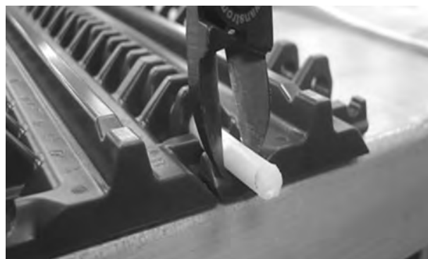
Figura 73: Estrazione del perno dal nastro
