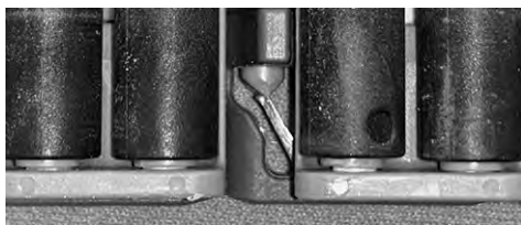
Figura 249: Assicurarsi che il perno sia inserito oltre il dispositivo di ritenzione
