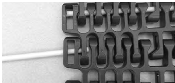
Figura 318: Inserimento del perno
