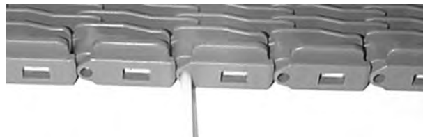
Figura 47: Inserimento del perno
