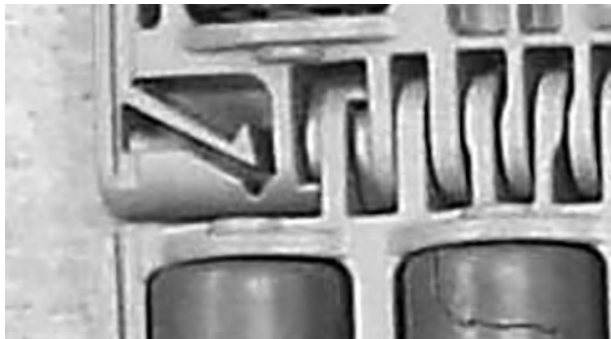
Figura 224: Assicurarsi che il perno sia inserito oltre il dispositivo di ritenzione
