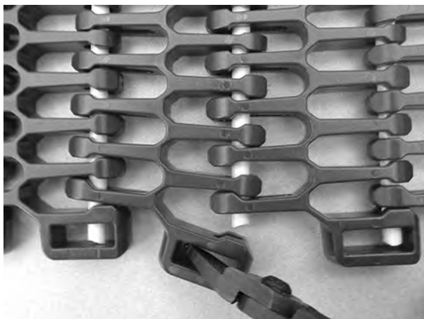
Figura 332: Flettere il bordo a filo del modulo
