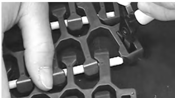
Figura 315: Flettere il bordo a filo del modulo sul perno libero
