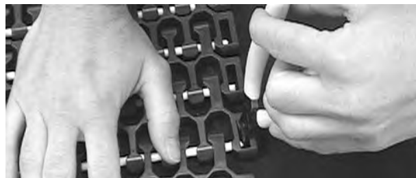
Figura 314: Spingere il perno nel nastro
