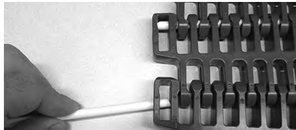
Figura 335: Inserimento del perno
