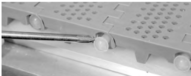
Figura 64: Spingere il perno nel nastro
