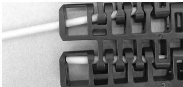
Figura 359: Inserire il perno nelle cerniere
