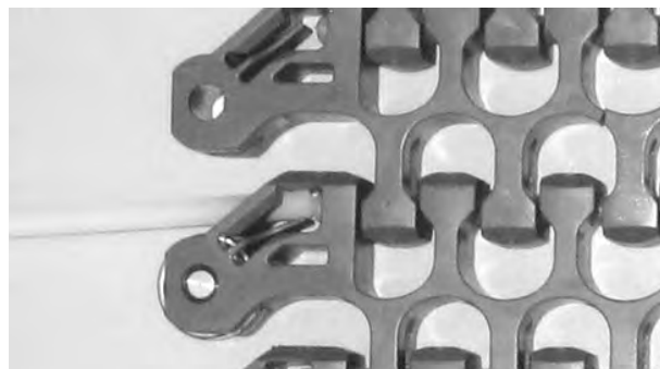
Figura 304: Estrazione del perno dal nastro
