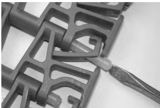
Figura 252: Spingere il perno oltre il dispositivo di ritenzione
