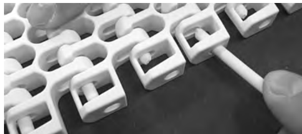
Figura 292: Inserire il perno nelle cerniere
