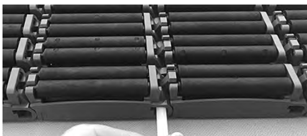
Figura 241: Inserire il perno nelle cerniere
