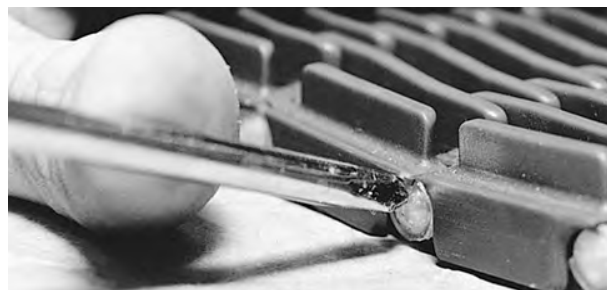
Figura 108: Assicurarsi che il perno superi il dispositivo di ritenzione a scatto
