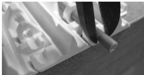
Figura 184: Estrazione del perno dal nastro
