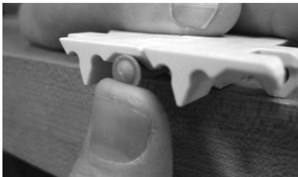
Figura 180: Utilizzare il pollice per spingere il perno
