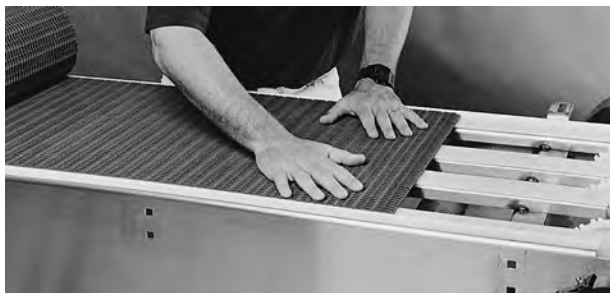
Figura 14: Far scorrere il nastro dall'estremità di azionamento
