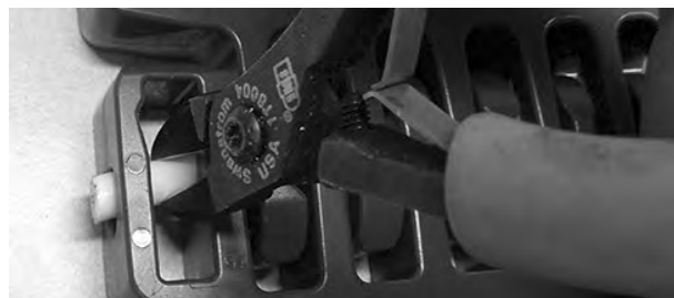
Figura 338: Spingere il perno lateralmente e oltre il foro chiuso
