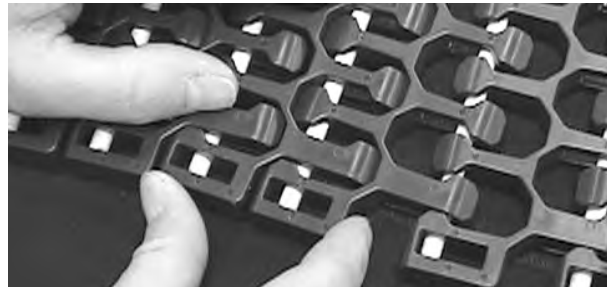
Figura 313: Assicurarsi che il perno sia inserito completamente
