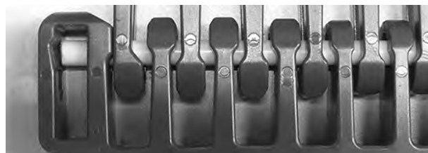
Figura 337: Assicurarsi che il perno sia inserito oltre il dispositivo di ritenzione
