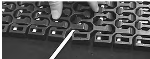
Figura 309: Inserire il perno nelle cerniere
