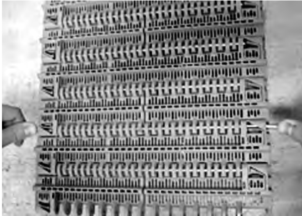
Figura 102: Estrazione del perno dal nastro
