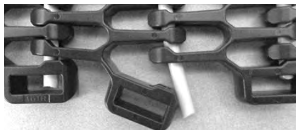
Figura 330: Spingere il perno oltre il bordo del nastro
