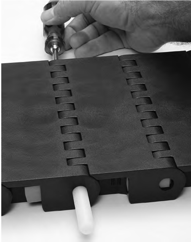
Figura 264: Allontanare il perno dal nastro
