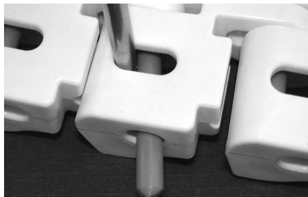
Figura 290: Spingere il perno attraverso il dispositivo di ritenzione
