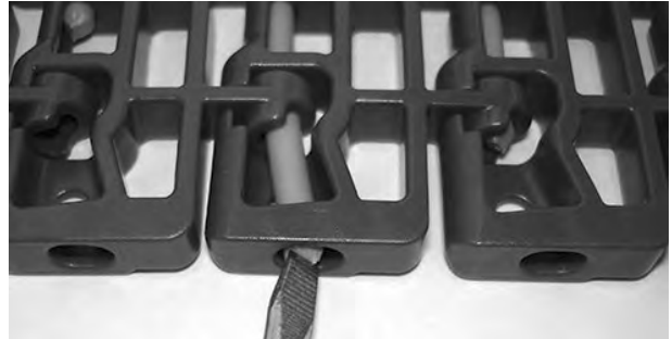
Figura 120: Spingere il perno oltre il dispositivo di ritenzione
