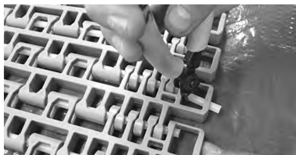
Figura 345: Estrazione del perno dal nastro
