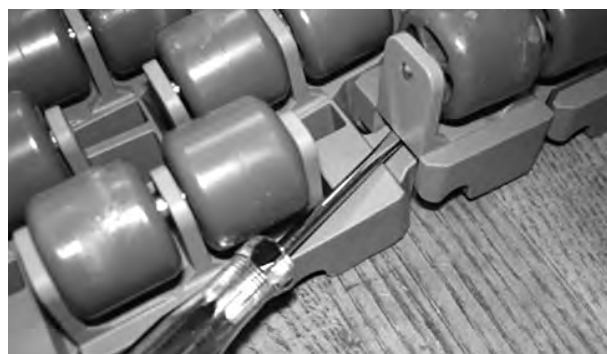
Figura 193: Inserire il cacciavite sotto il rullo
