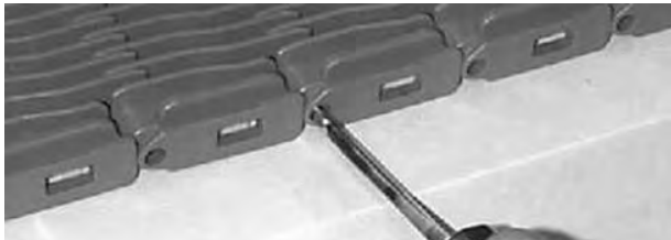
Figura 50: Allontanare il perno dal nastro
