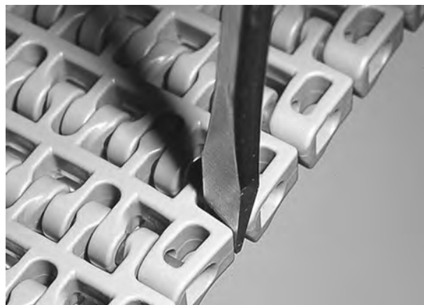
Figura 139: Spingere il perno oltre il dispositivo di ritenzione
