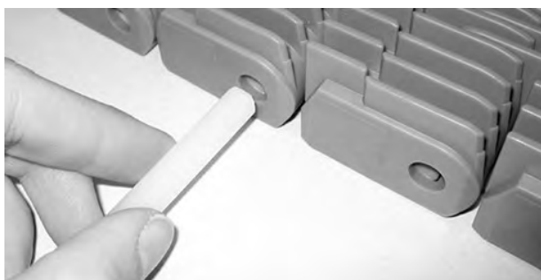
Figura 216: Inserire il perno nelle cerniere
