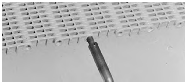
Figura 36: Chiudere il foro del perno
