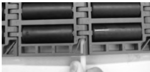
Figura 237: Inserire il perno nelle cerniere
