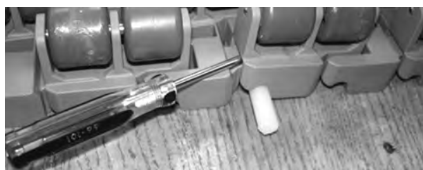
Figura 196: Estrazione del perno dal nastro
