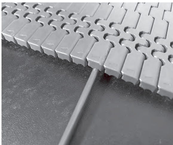
Figura 59: Inserimento del perno
