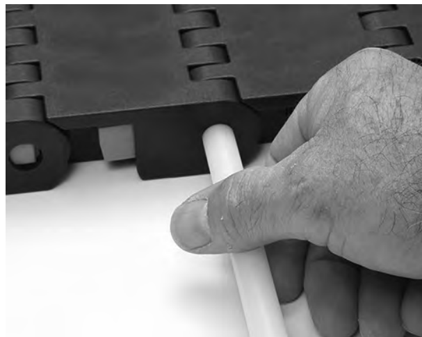
Figura 263: Inserimento del perno
