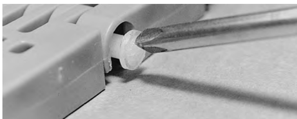
Figura 43: Spingere il perno nel nastro
