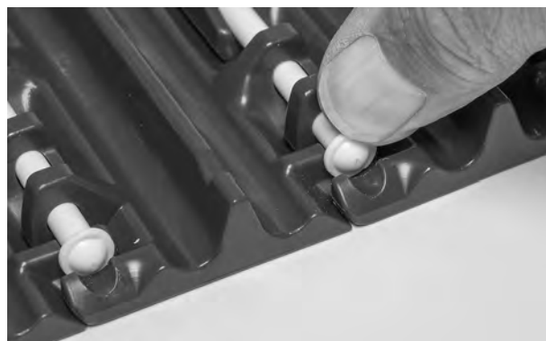
Figura 94: Spingere il perno oltre il dispositivo di ritenzione
