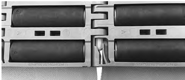
Figura 242: Spingere il perno oltre il dispositivo di ritenzione
