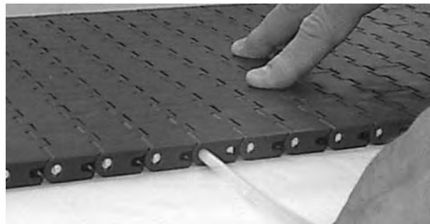
Figura 162: Inserimento del perno
