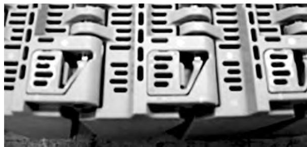
Figura 101: Assicurarsi che il dispositivo di ritenzione sia chiuso
