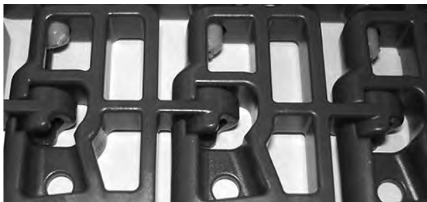
Figura 112: I perni si spostano all'interno del bordo a filo
