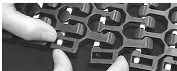
Figura 312: Spingere il perno oltre il bordo del nastro, far scattare il bordo a filo oltre il perno
