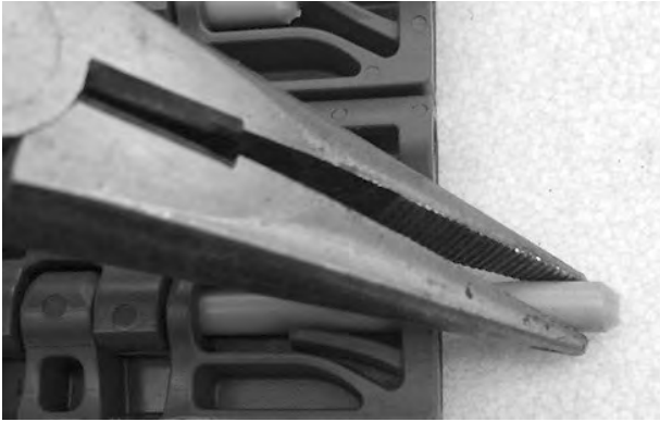
Figura 132: Estrazione del perno dal nastro
