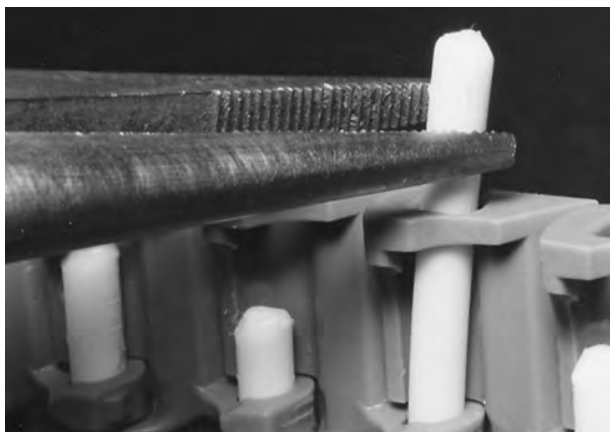
Figura 150: Estrazione del perno dal nastro
