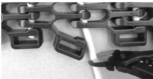
Figura 334: Estrazione del perno dal nastro
