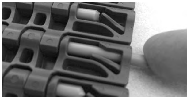
Figura 128: Inserire il perno nella cerniera
