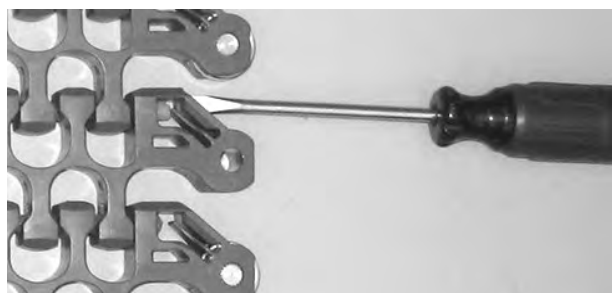
Figura 303: Aprire il dispositivo di ritenzione
