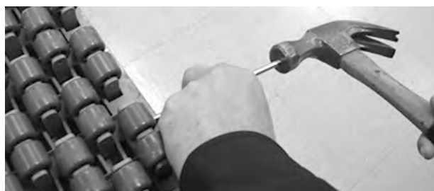
Figura 195: Allontanare il perno dal nastro
