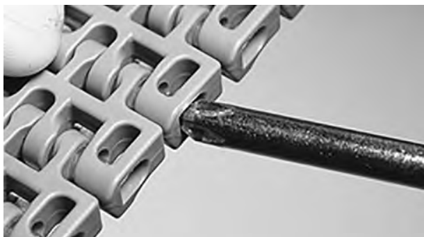
Figura 146: Spingere il perno oltre il dispositivo di ritenzione
