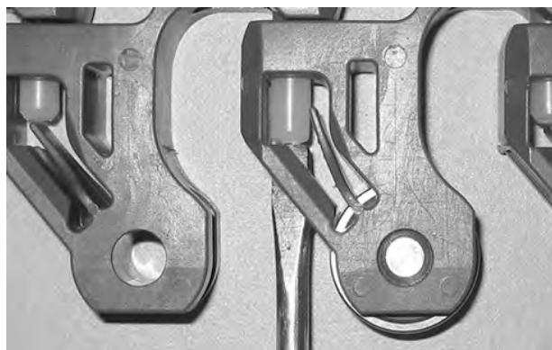
Figura 283: Spingere il perno oltre il dispositivo di ritenzione
