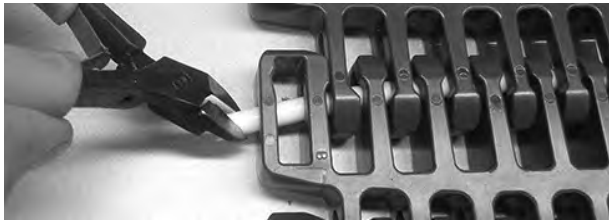
Figura 339: Estrazione del perno dal nastro
