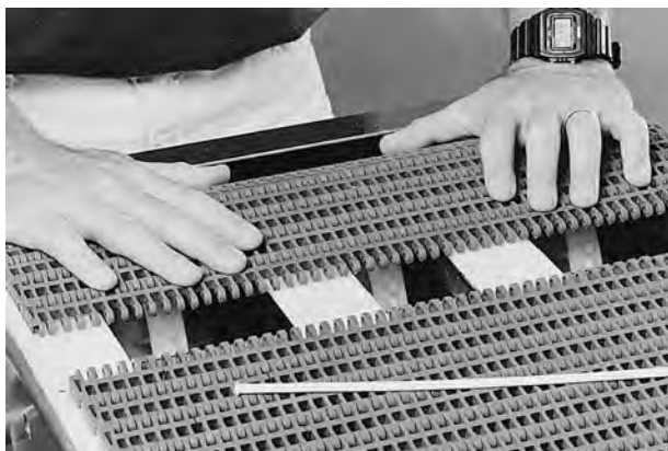
Figura 19: Avvicinare le estremità del nastro
