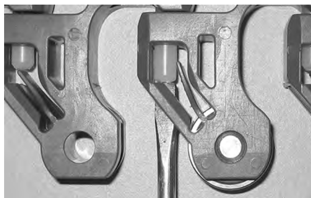
Figura 305: Spingere il perno oltre il dispositivo di ritenzione
