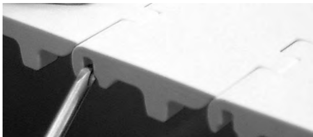
Figura 205: Spingere il perno oltre il dispositivo di ritenzione
