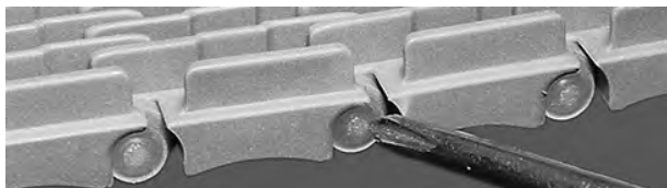
Figura 29: Assicurarsi che la testa del perno superi il dispositivo di ritenzione a scatto
