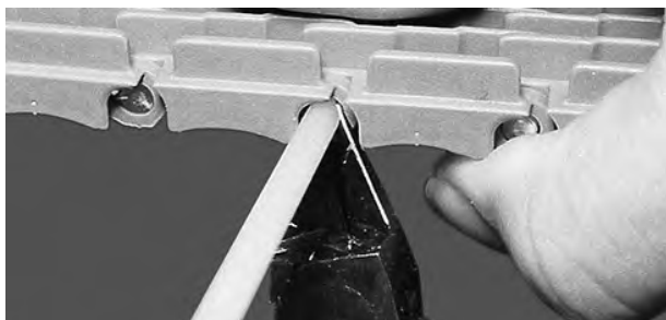
Figura 30: Tagliare il perno a filo con il bordo del nastro
