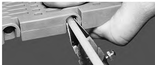
Figura 45: Tagliare il perno a filo con il bordo del nastro
