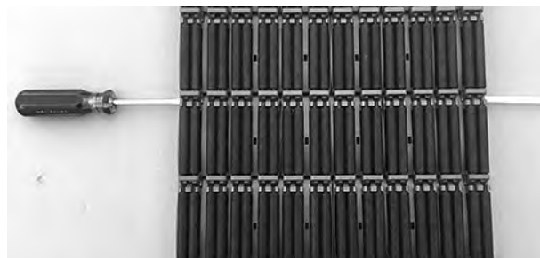
Figura 244: Allontanare il perno dal nastro
