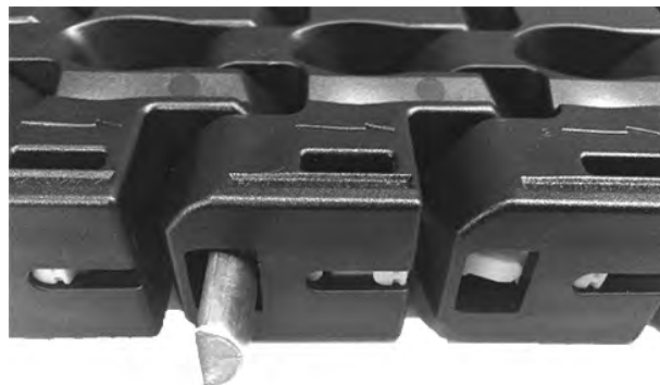
Figura 200: Inserimento del perno
