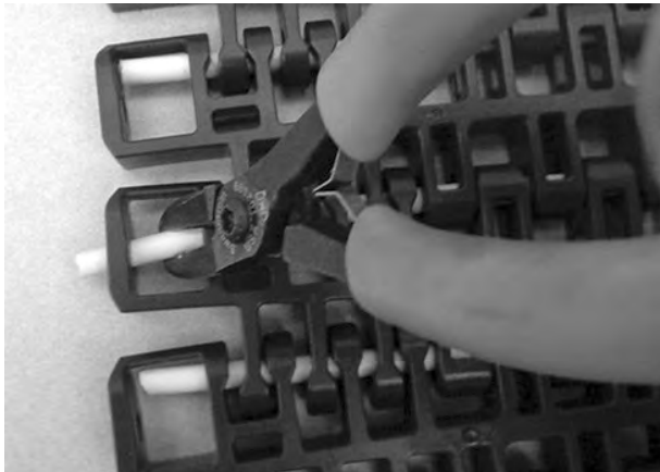
Figura 362: Spingere il perno oltre il dispositivo di ritenzione
