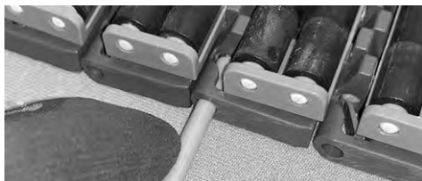
Figura 247: Inserire il perno nelle cerniere
