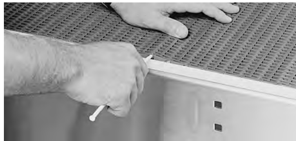
Figura 21: Inserimento del perno
