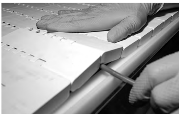
Figura 89: Piegarlo leggermente il perno e inserirlo attraverso le cerniere
