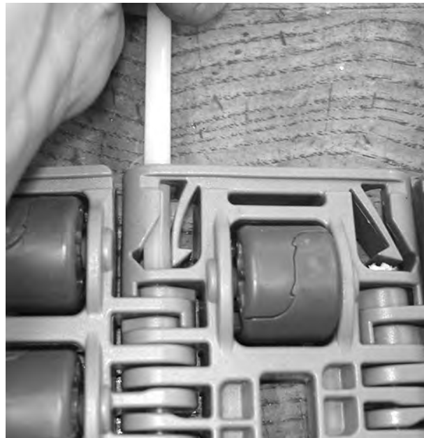
Figura 222: Allontanare il perno dal nastro
