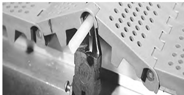
Figura 66: Tagliare il perno a filo con il bordo del nastro
