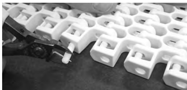
Figura 296: Estrazione del perno dal nastro
