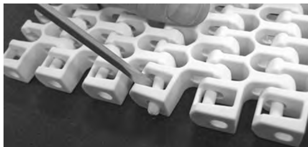
Figura 295: Spingere il perno attraverso il dispositivo di ritenzione
