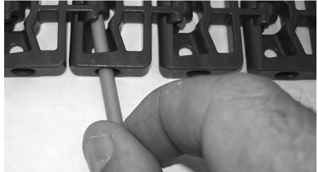
Figura 119: Inserire il perno nelle cerniere
