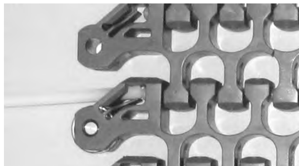
Figura 286: Allontanare il perno dal nastro
