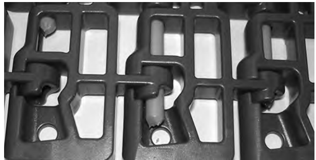
Figura 121: Assicurarsi che il perno sia inserito completamente
