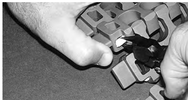
Figura 278: Liberare il perno dal dispositivo di ritenzione
