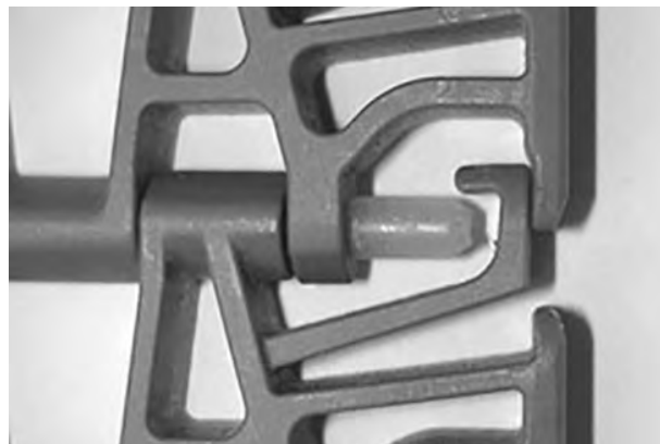
Figura 253: Assicurarsi che il perno sia inserito oltre il dispositivo di ritenzione
