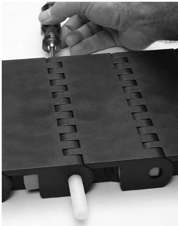
Figura 268: Allontanare il perno dal nastro
