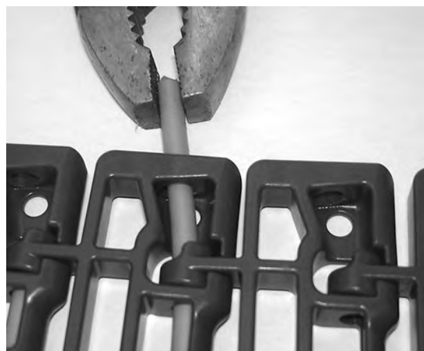
Figura 123: Estrazione del perno dal nastro
