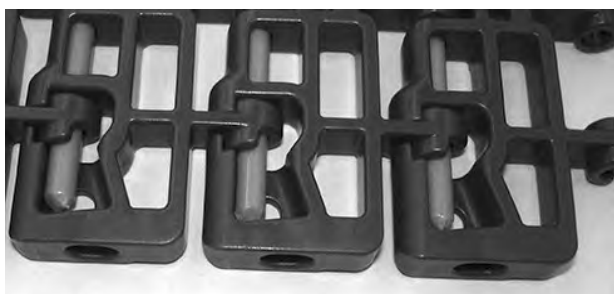
Figura 113: Il perno si espande nel bordo a filo
