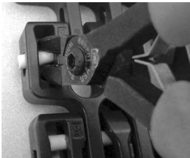
Figura 321: Spingere il perno lateralmente e oltre il foro
