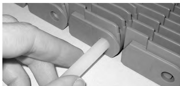
Figura 219: Estrazione del perno dal nastro
