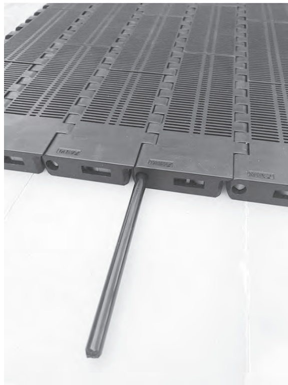
Figura 211: Inserimento del perno
