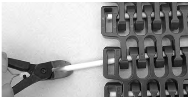
Figura 322: Estrazione del perno dal nastro
