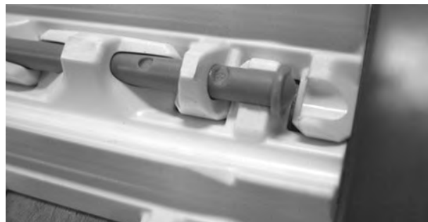
Figura 182: Assicurarsi che il perno sia inserito completamente
