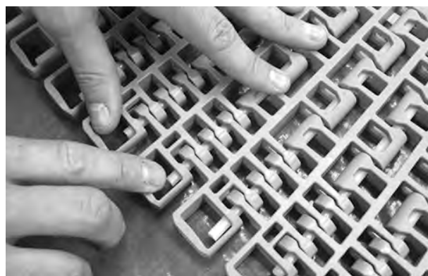
Figura 344: Assicurarsi che il perno sia inserito oltre il dispositivo di ritenzione
