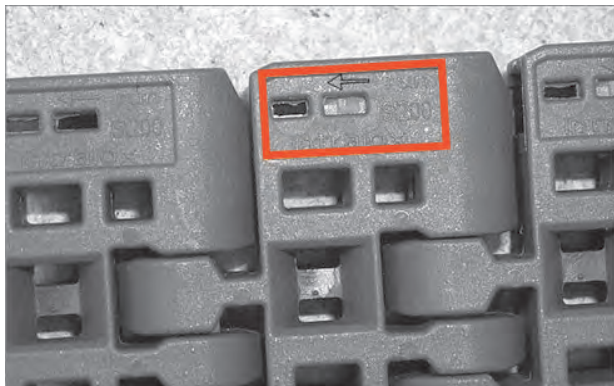
Figura 155: Direzione di scorrimento del nastro
