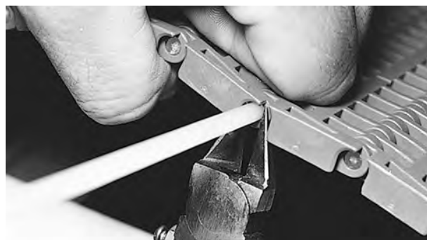
Figura 109: Tagliare il perno a filo con il bordo del nastro
