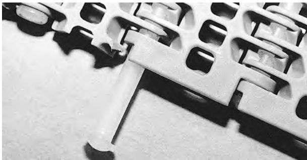
Figura 34: Inserimento del perno
