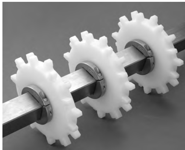
Figura 323: Fissare entrambi i lati di tutti i pignoni
