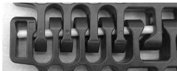
Figura 320: Assicurarsi che il perno sia inserito oltre il dispositivo di ritenzione
