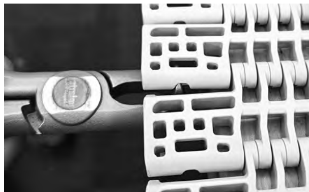
Figura 126: Utilizzare un estrattore perni per afferrare il perno
