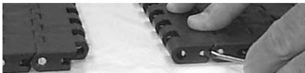
Figura 161: Utilizzare un cacciavite per chiudere lo Slidelox
