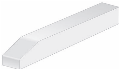
図 67: ウェアストリップ端の面取り
