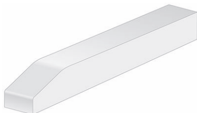
図 35: ウェアストリップ端の面取り
