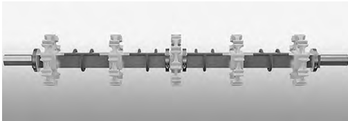
Abbildung 146: Zahnrad-Distanzstücke an der Vierkantwelle mit Zahnrädern und Halteringen
