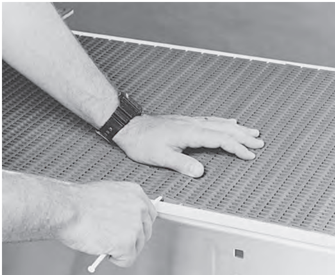
Abbildung 1: Kunststoffmodule, verbunden mit Scharnierstäben
