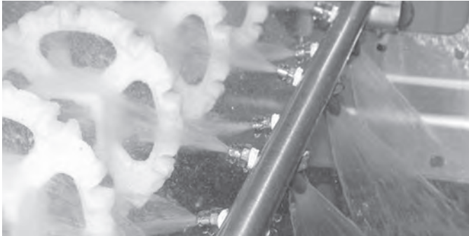
Abbildung 164: Spritzbildkonstruktion zur gründlichen Reinigung der Bandunterseite, der Zahnräder und der Welle
