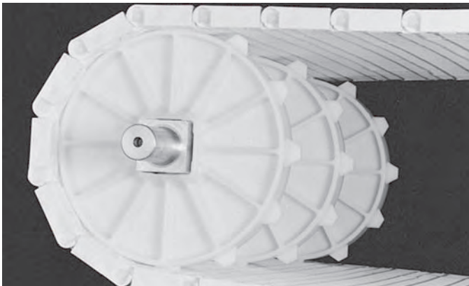
Abbildung 4: Zahnräder mit Vierkantbohrung auf Vierkantwelle
