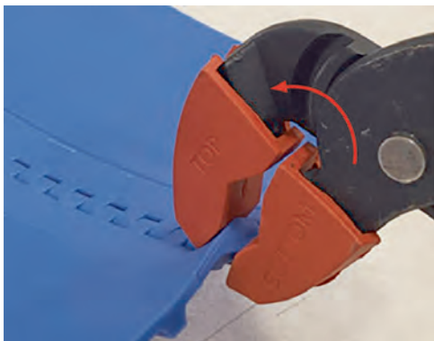
Figura 9: Flettere il bordo del nastro verso l'alto per bloccare l'estremità del perno
