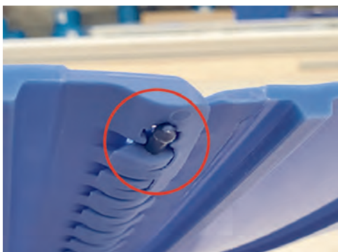
Figura 4: Assicurarsi che l'estremità del perno si arresti a 0,125 poll. dal bordo del nastro
