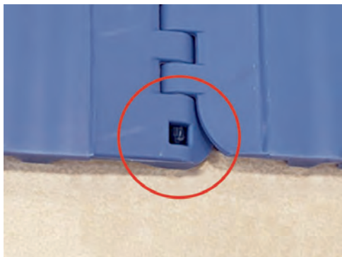
Figura 7: Assicurarsi che le estremità dei perni siano visibili in entrambi i vetri spia
