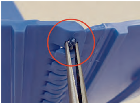
Figura 11: Utilizzare la pinza per serrare il perno
