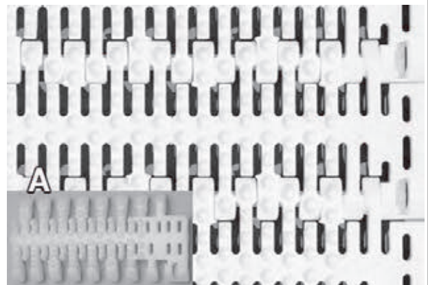
A Einsatz: Kantenmodul aus Polyäthylen
