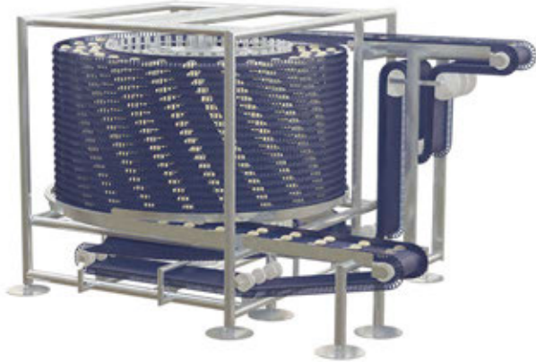
Abbildung 178: Spiralförderer mit DirectDrive-Stapler
