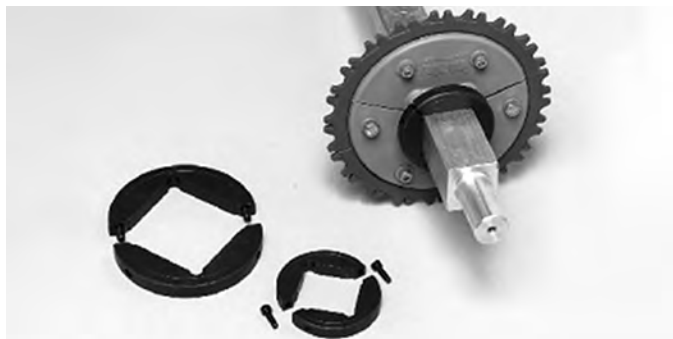
Abbildung 101: Halteringe mit geteiltem Kragen
