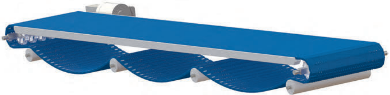
Abbildung 145: Untertrum mit vollwertigem Banddurchhang
