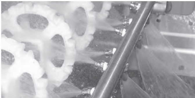
Abbildung 120: Spritzbildkonstruktion zur gründlichen Reinigung der Bandunterseite, der Zahnräder und der Welle
