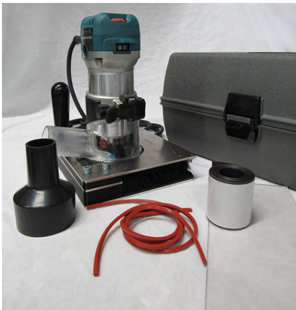
Figura 58: Set fresa per le estremità dei nastri
