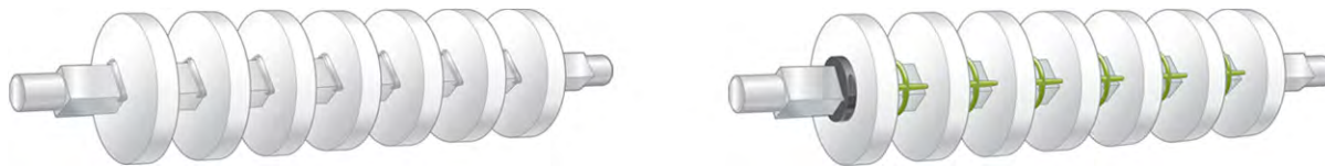
Rysunek 23: Pierścienie ustalające i elementy dystansowe kół zębatych
