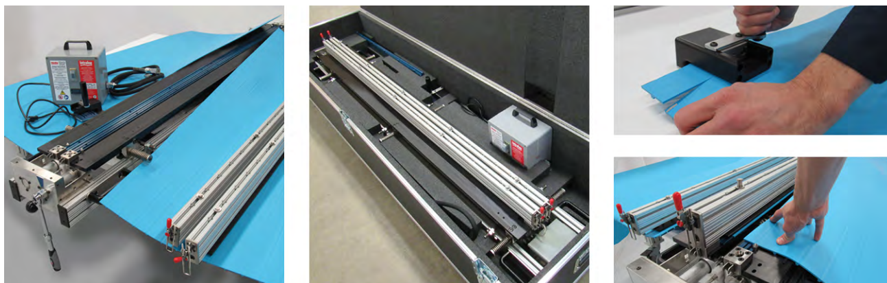
Rysunek 56: Zestaw do łączenia ThermoDrive Streamline i jego elementy
