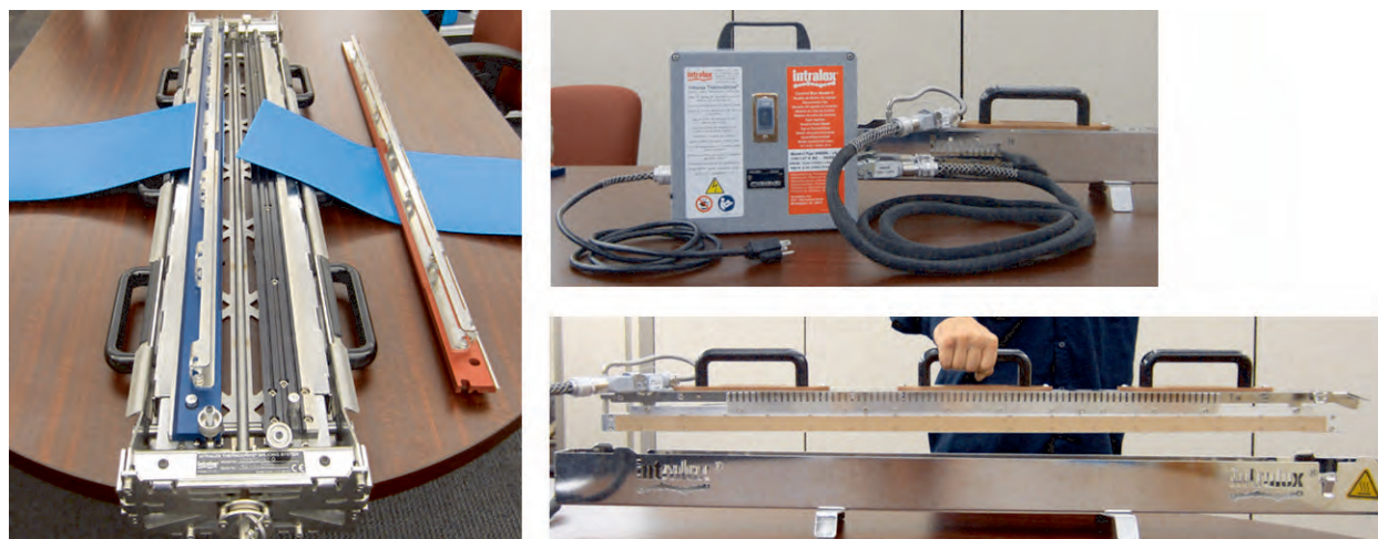
Figura 22: Sistema di giunzione ThermoDrive V2 e componenti
