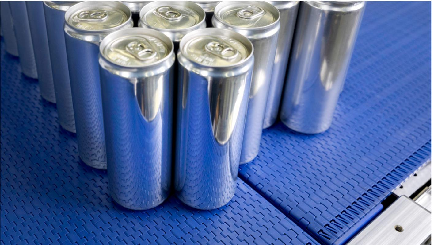
Vermeiden Sie unnötige Förderer-, Förderband- und Wartungsprobleme, indem Sie Side-by-Side-Förderer und problematische Übergaben eliminieren. Das Tight Transfer-Förderband der Serie 570 und die Messerkanten-Übergabeeinheit von Intralox® sind perfekt aufeinander abgestimmt.
