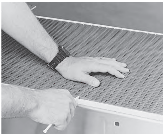
Figure 1: Modules en matière plastique assemblés par des axes de charnière
