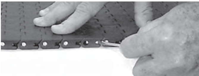
Figure 127: Système de retenue des axes Slidelox
