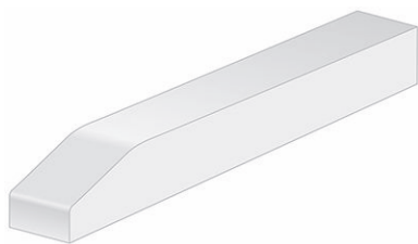
Figure 64: Chanfrein d'extrémité de glissière
