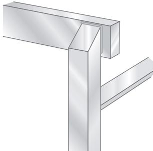
图 28: 正确的接头组件
