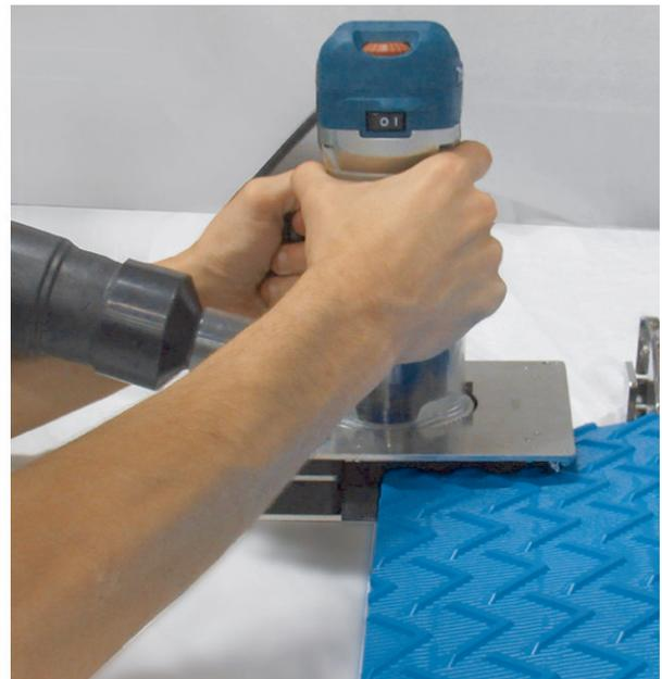
图 22: 传送带端头槽刨套件
