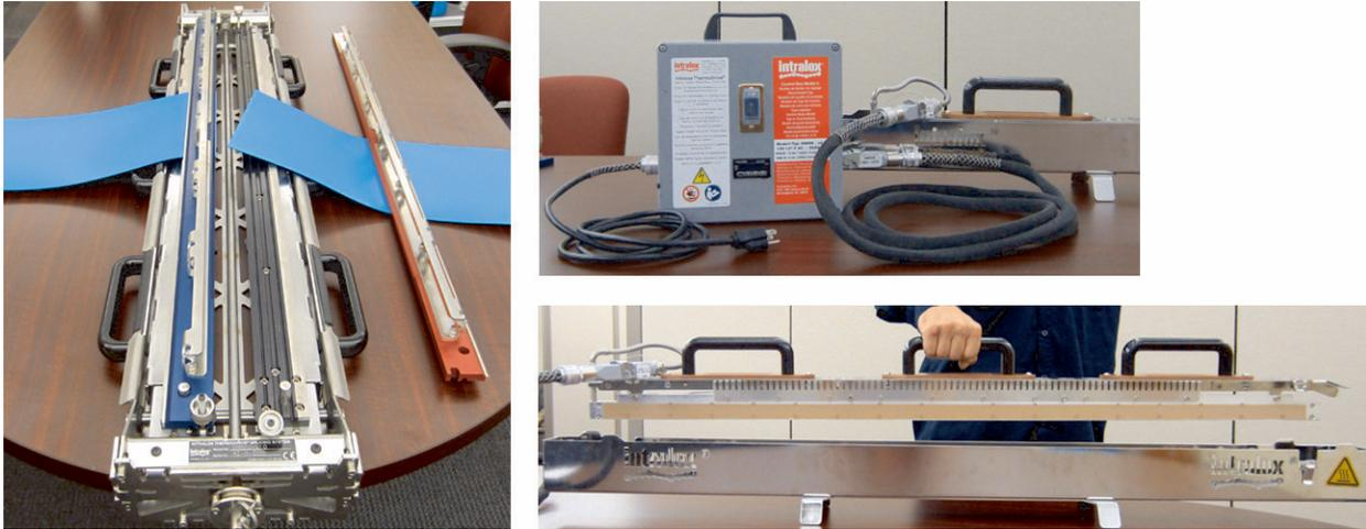
图 19: 热塑驱动拼接系统 V2 和部件
