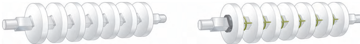
Rysunek 21: Pierścienie ustalające i elementy dystansowe kół zębatach
