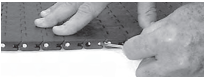
図 127: スライドロック式ロッド保持機構
