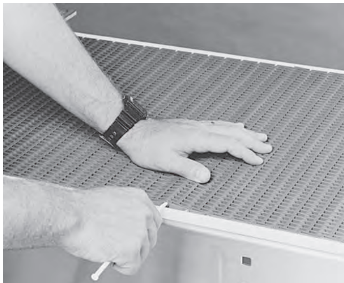
図 1: ヒンジロッドによって連結されたプラスチックモジュール
