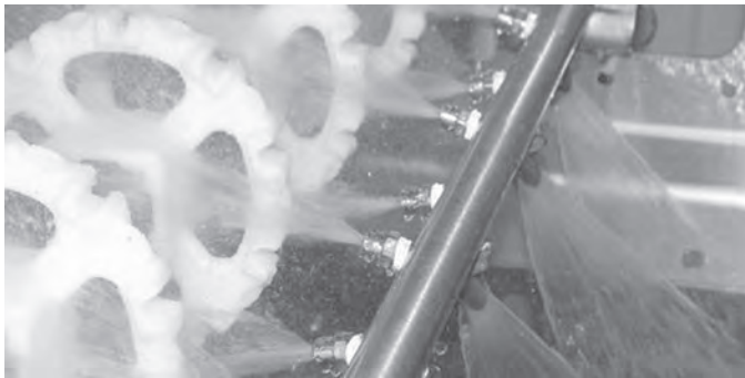
図 120: ベルトの裏側やスプロケット、シャフトの洗浄用に設計されたスプレーパターン
