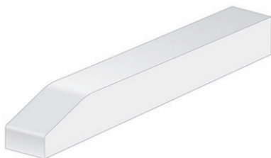
Abbildung 64: Endabschrägung der Gleitleiste
