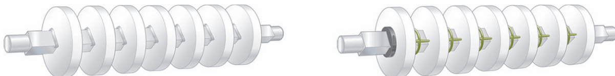
Abbildung 57: Halteringe und Distanzstücke am Zahnrad
