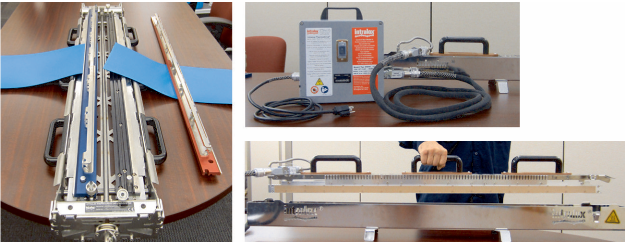
Abbildung 19: ThermoDrive-Spleißsystem v2 und Komponenten
