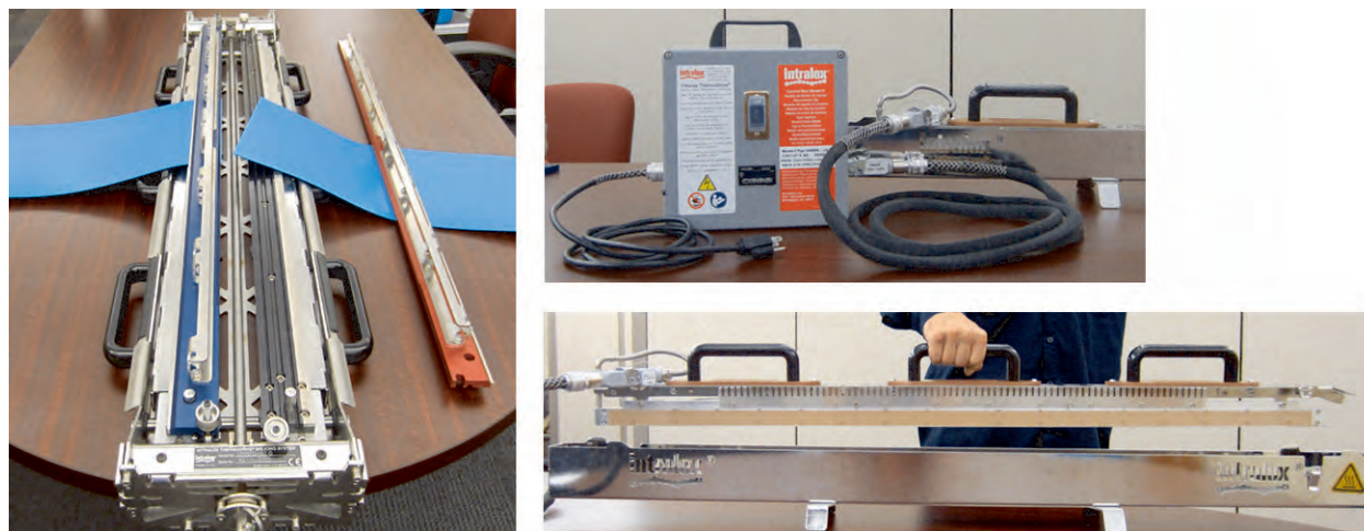
Figura 56: Sistema di giunzione ThermoDrive V2 e componenti
