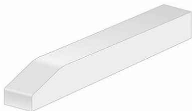
Figura 35: Bisel del extremo de la guía de desgaste
