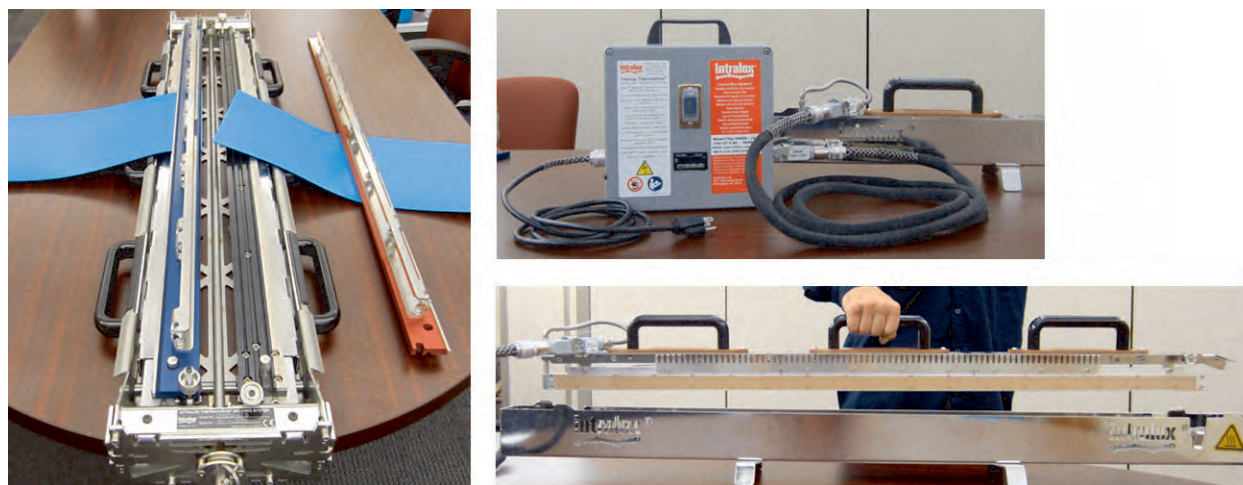
Figura 22: Sistema de uniones térmicas ThermoDrive V2 y componentes
