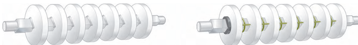
Figura 60: Anillos de retención y separadores de engranajes
