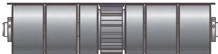
Figura 2: Engranaje apilado/rueda de soporte (engranaje cuadrado de 6 pulg. de ancho)
