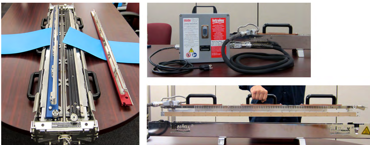
Figura 55: Sistema de uniones térmicas ThermoDrive V2 y componentes
