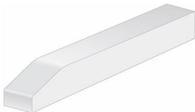
**Figura 67:** Guia de desgaste e chanfro
