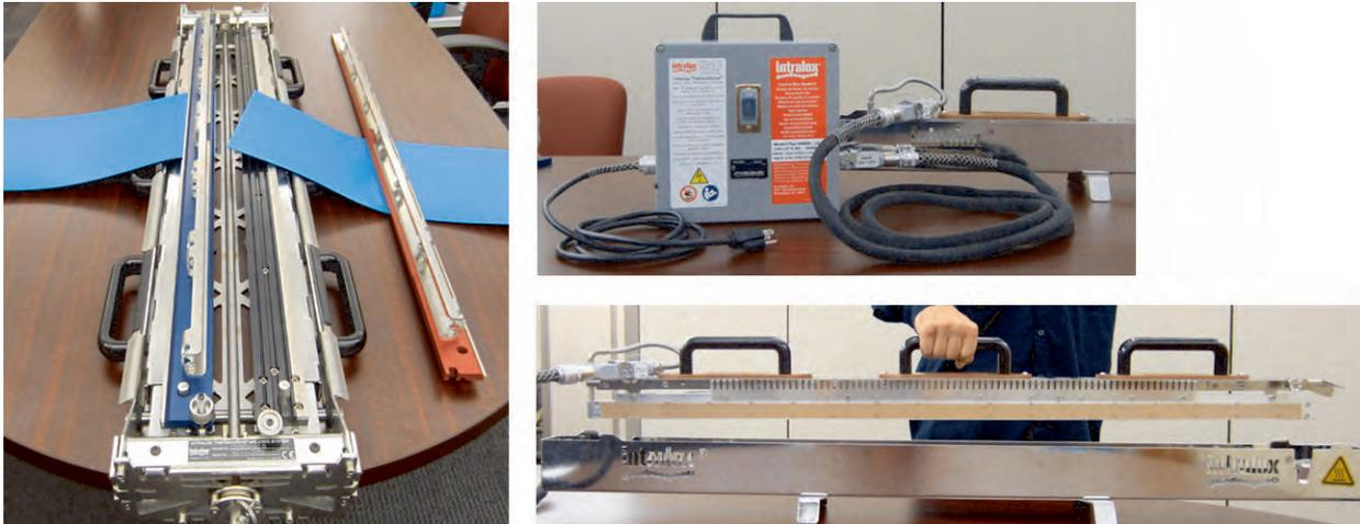
Figura 22: Sistema de emenda e componentes ThermoDrive V2
