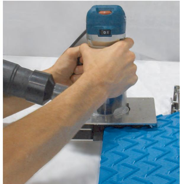
Figura 25: Conjunto da fresadora de extremidade para esteira
