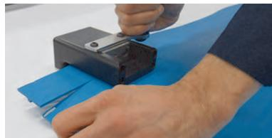
Figura 24: Ferramenta portátil de preparação da esteira
