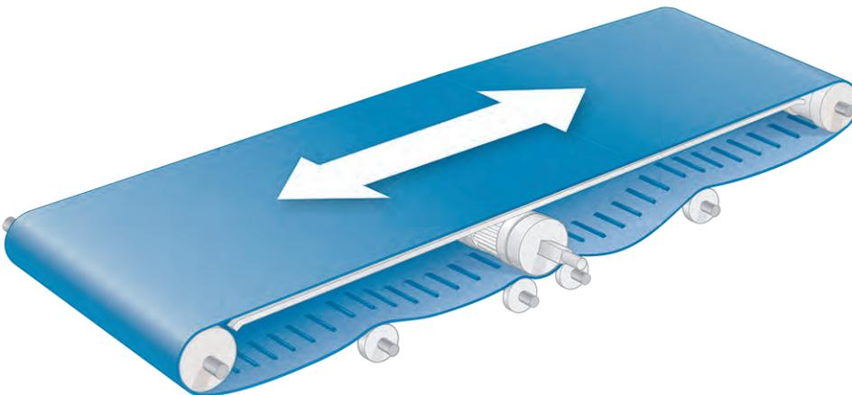
**Figura 73:** Locais da engrenagem de acionamento central e do limitador de posição
