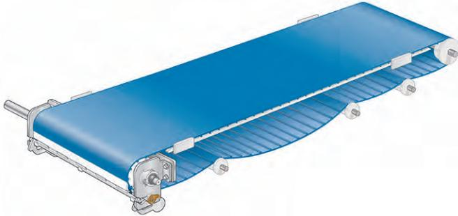
**Figura 40:** Curvatura catenária entre os componentes
