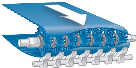
Figure 49: Installation des pignons extérieurs
