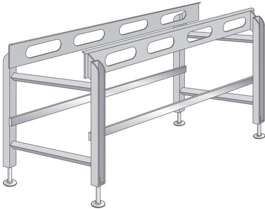
**Figure 30:** Une structure simple pour un accès ouvert lors du nettoyage
