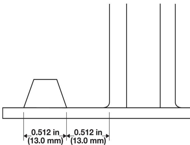
Figure 12: Retraits pour une voie de guidage en V
