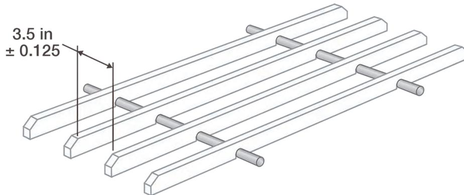
Figure 78: Dimensions de l'espacement entre les rails de maintien
