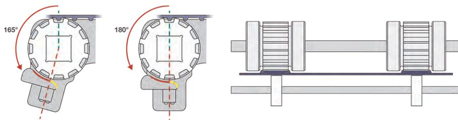
Figure 75: Positionnement du limiteur de position entre 165 degrés et 180 degrés
