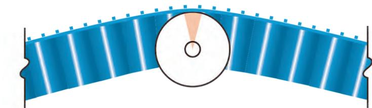
**Figure 10:** Angle d'enroulement faible (voir le tableau suivant : Données relatives au flanc synchronisé S8050)
