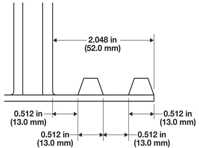
Figure 13: Retraits pour deux voies de guidage en V
