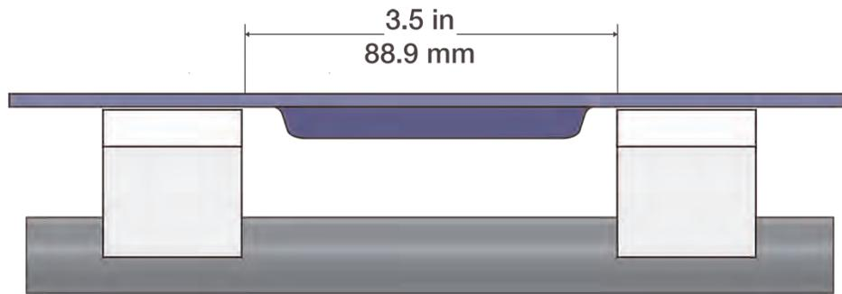
Figure 77: Rangée d'ergots simple entre les rails de maintien
