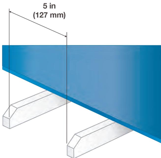
Figure 79: Alignement des ergots dans l'espacement entre les rails de maintien
