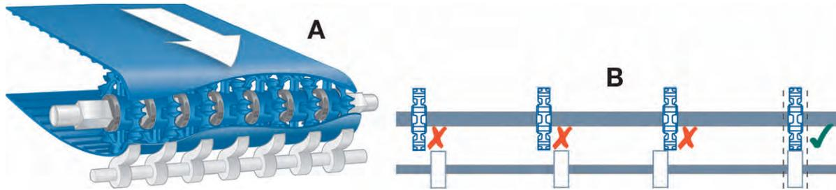
Figure 55: Alignement adéquat et espacement minimal pour les tapis sans accessoires
