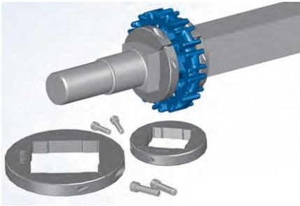
Figure 16: Circlip renforcé en deux parties
