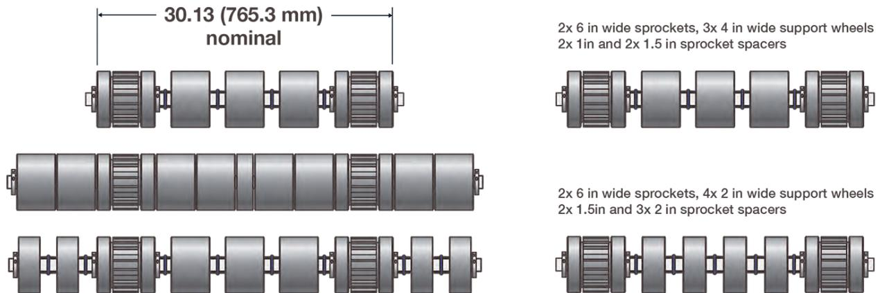
Figure 3: Espacement entre le pignon d'entraînement et le rouleau de renvoi
