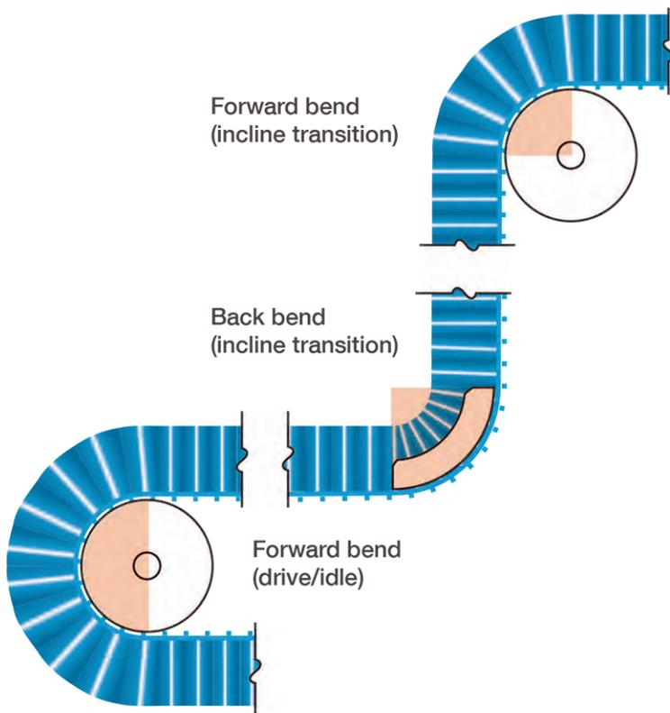
**Figure 9:** Angle d'enroulement élevé (voir le tableau suivant : Données relatives au flanc synchronisé S8050)
