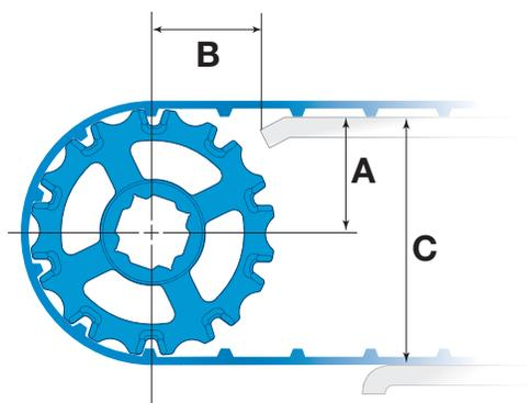
Figure 14: Dimensions de l'extrémité d'entraînement
