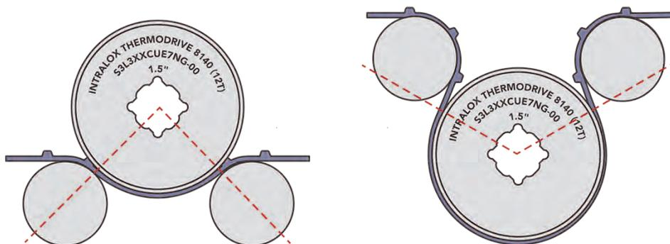
Figure 74: Engrenement du tapis dans les pignons à 90 et 225 degrés
