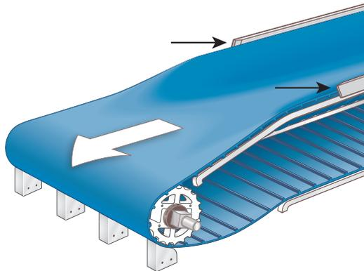
Figure 81: Rails de maintien PE-1000
