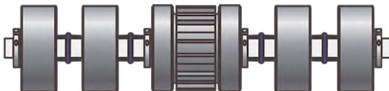
Figure 1: Pignon espacé / roue de support (pignon avec un alésage carré large de 6 pouces)
