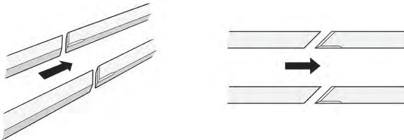
**Figure 34:** Rails chanfreinés à un angle de 45 degrés
