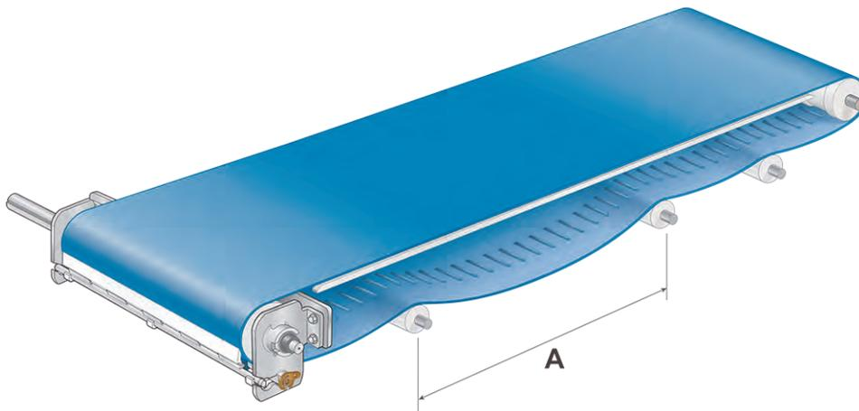
Figure 71: Espacement adéquat entre les supports
