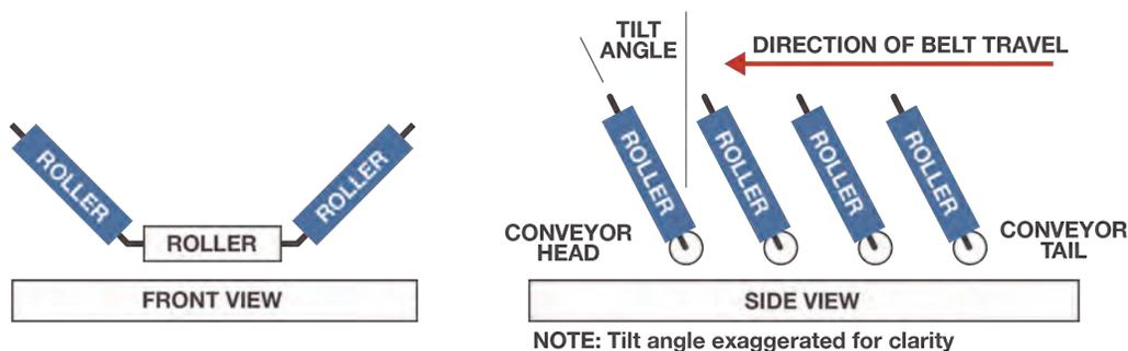
Figure 69: Angles d'inclinaison et sens de défilement du tapis
