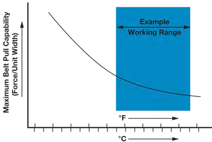
Figure 86: La température affecte la capacité de traction maximale du tapis
