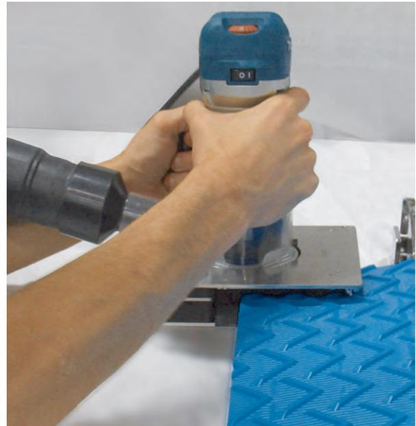
Figure 25: Kit de fraiseuse pour extrémités de tapis
