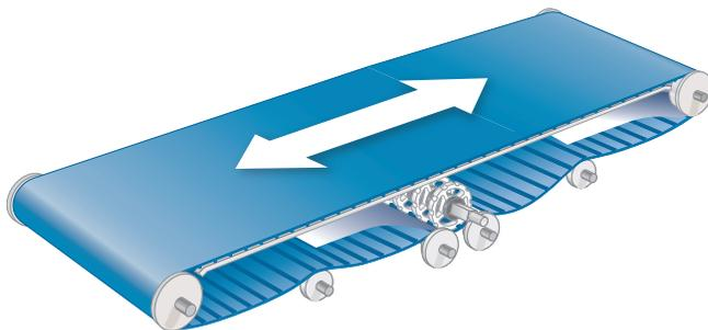
Figure 57: Emplacements du pignon d'entraînement central et du limiteur de position
