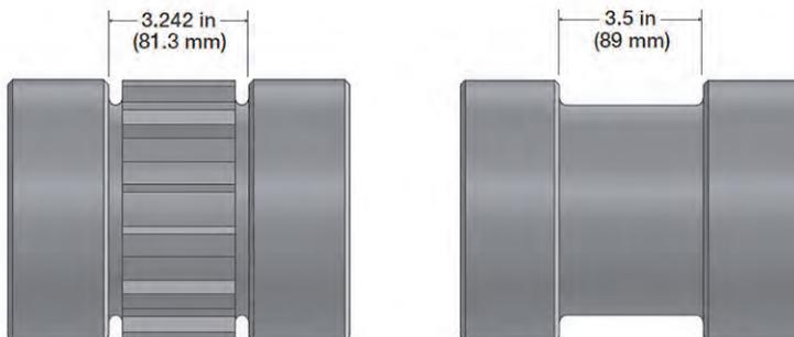
Figure 76: Dimensions internes des pignons et des rouleaux
