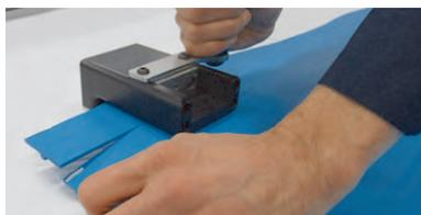
Figure 24: Outil de préparation portable de tapis
