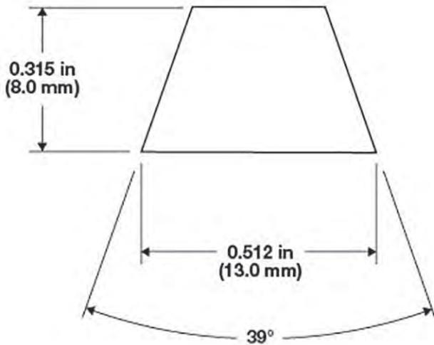
Figure 11: Géométrie nominale du guidage en V
