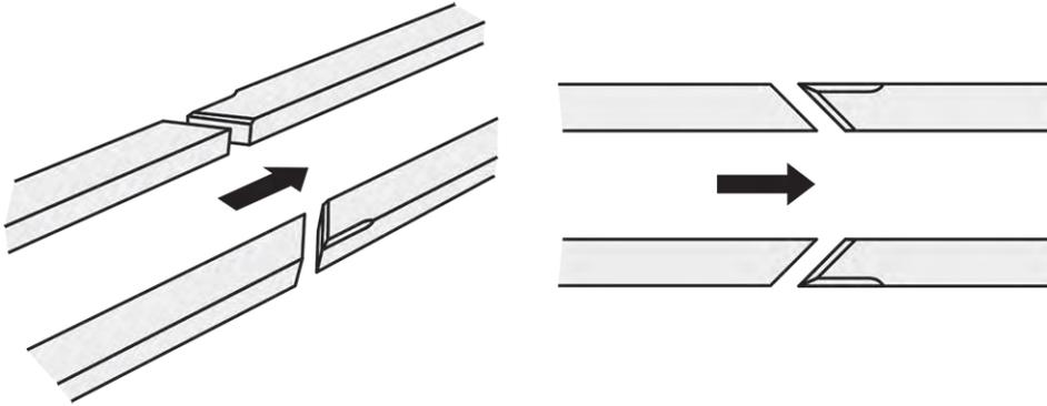
Figure 68: Rails chanfreinés à un angle de 45 degrés
