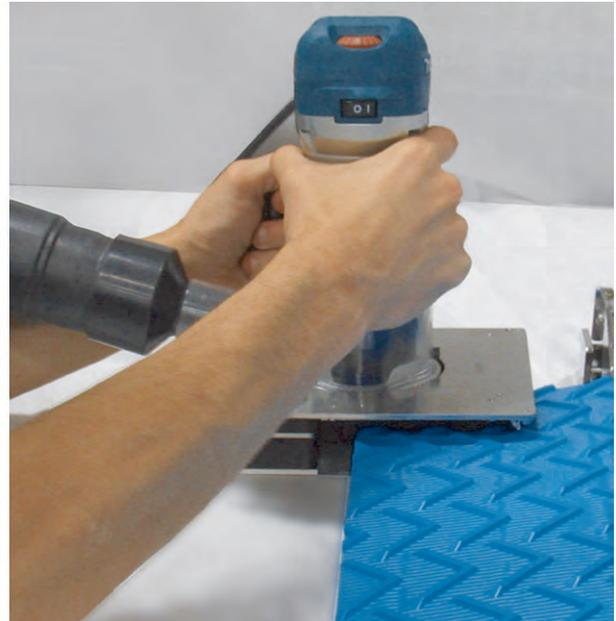
Figure 59: Kit de fraiseuse pour extrémités de tapis
