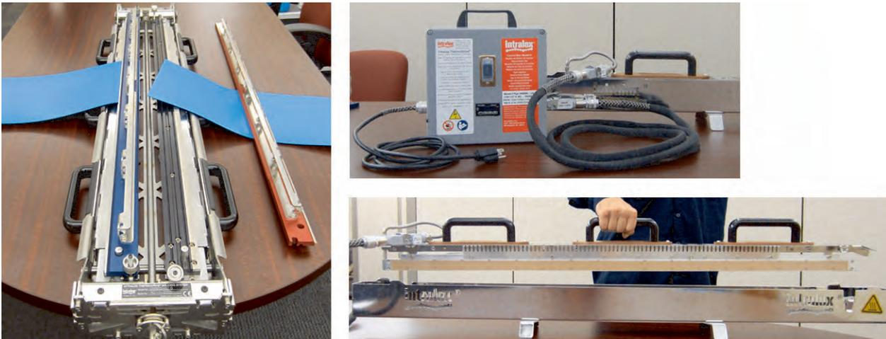
Figure 56: Système de raccordement ThermoDrive V2 et composants
