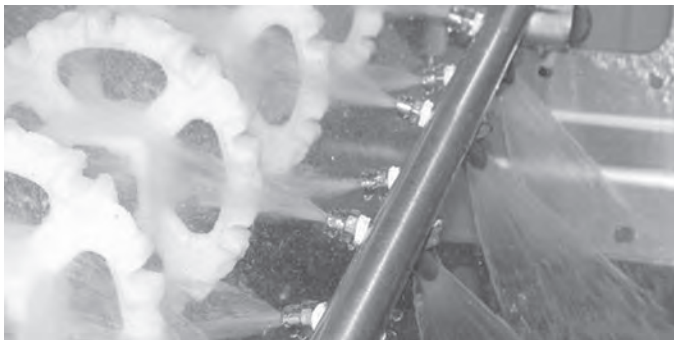
Rysunek 164: Wzór natryskiwania został zaprojektowany w celu dokładnego czyszczenia spodniej części taśmy, kół zębatach i wału
